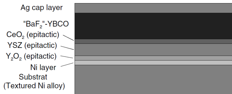
Σχήμα 1.21 Ταινία από YBa_2Cu_3O_7 παρασκευασμένη με τη μέθοδο RABITS σε υπόστρωμα από κράμα Νικελίου. [Buckel, 2004, σελ.360]
