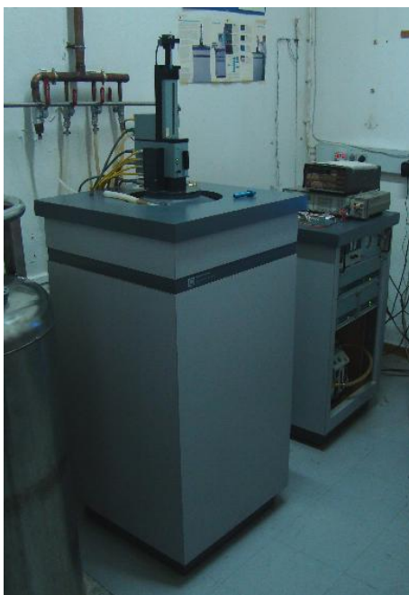
Σχήμα 2.1 Το SQUID του Ινστιτούτου Επιστήμης Υλικών στο Εθνικό Κέντρο Έρευνας Φυσικών Επιστημών “Δημόκριτος”.
