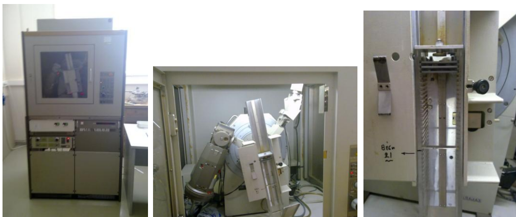
Σχήμα 2.9 Το Περιθλασιόμετρο Ακτίνων X του Ινστιτούτου Επιστήμης Υλικών στο Εθνικό Κέντρο Έρευνας Φυσικών Επιστημών “Δημόκριτος”. Στην δεξιά εικόνα φαίνεται ο χώρος που τοποθετούνται οι ειδικοί δειγματοφορείς (holder).
