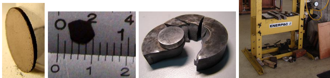
Σχήμα 3.2 Αριστερά: Συμπιεσμένο δοκίμιο με μηχανική θλιπτική καταπόνηση έντασης 1.1\text{GPa} . Κέντρο αριστερά: Υβριδικό δοκίμιο, αφού έχει κοπεί κατάλληλα για τις μαγνητικές μετρήσεις. Διακρίνεται το μέγεθος του δείγματος. Η μεσαία κλίμακα που δείχνει τον αριθμό “1” αντιστοιχεί σε \text{cm} με τις ενδιάμεσες γραμμές να δείχνουν τα \text{mm} . Η κάτω ένδειξη είναι του βερνιέρου και αντιστοιχεί στα δέκατα του \text{mm} . Κέντρο δεξιά: Θραυσμένη βάση καλουπιού μετά από απόπειρα συμπίεσης 1.4\text{GPa} . Δεξιά: Η υδραυλική πρέσα στο μηχανουργείο του ΕΚΕΦΕ “Δημόκριτος”.
