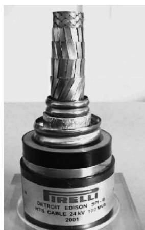
Σχήμα 1.24 Υπεραγωγίμο καλώδιο του “Detroit Edison Project”. Το υπεραγωγίμο υλικό είναι Bi_2Sr_2Ca_2Cu_3O_{10} . Το μήκος του είναι 120m και η συνολική διάμετρος 10cm. [Buckel, 2004, σελ.382]
