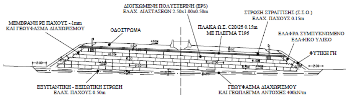
Εικόνα 3.7 :Τυπική διατομή επιχώματος και διάταξης μέτρων βελτίωσης (Παπαχαραλάμπους κ.α ,2010)
