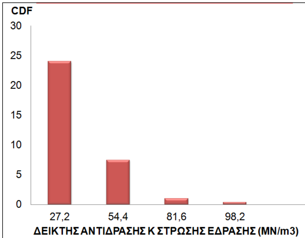
Σχήμα 5.24: Επίδραση της μεταβολής του δείκτη αντίδρασης K στρώσης έδρασης στο δείκτη αθροιστικής φθοράς
