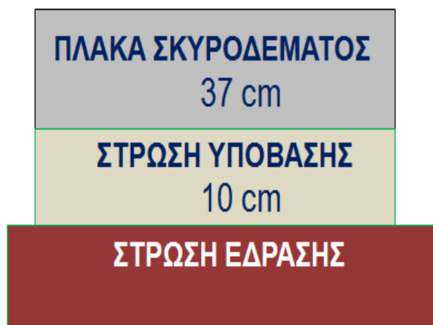
Σχήμα 4.1: Διατομή δύσκαμπτου οδοστρώματος – εμπειρική μέθοδος
