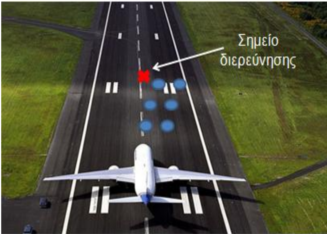
Σχήμα 2.5: Έννοια καλύψεων – διελεύσεων C αεροσκαφών
