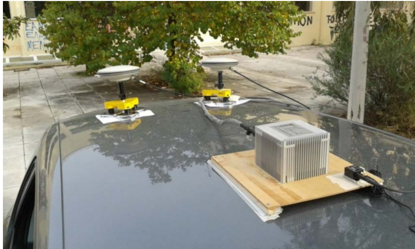
Σχήμα 6.5: Κεραίες GNSS, αδρανειακή μονάδα SPAN και σύστημα GNSS/INS Advance Navigation SPATIAL επί του οχήματος
