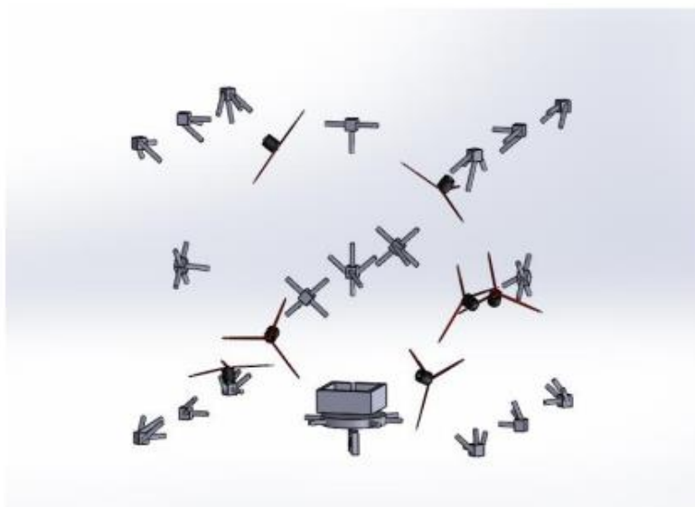
Εικόνα 29 – Εισαγωγή στηριγμάτων για την κατασκευή του πλαισίου
