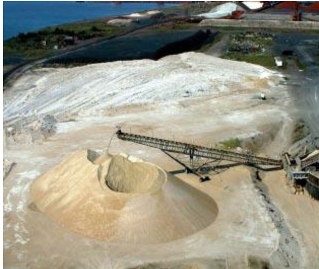
Εικόνα 6.2 Σκωρία υψικαμίνου από εργοστάσιο τήξης σιδήρου [5]
