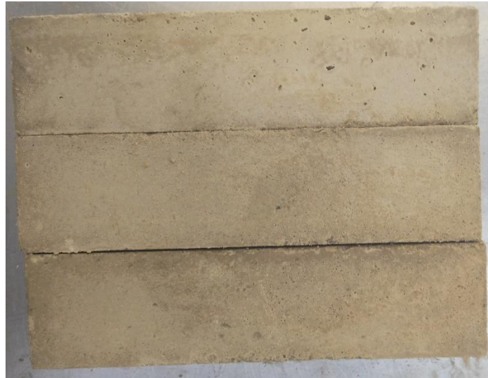
Εικόνα 12.1 Θειοαλουμινικό τσιμέντο με 20% Ποζολάνη
