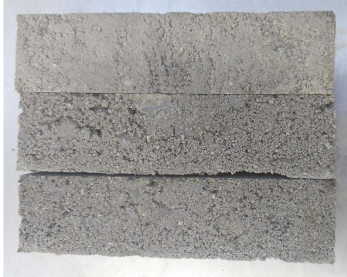
Εικόνα 12.3 Θεριοαλουμινικό τσιμέντο με 20% Ιπτάμενη τέφρα
