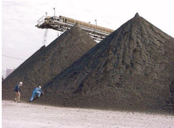
Εικόνα 6.1 Απόβλητα ιπτάμενης τέφρας από εργοστάσιο παραγωγής ηλεκτρικής ενέργειας [5]
