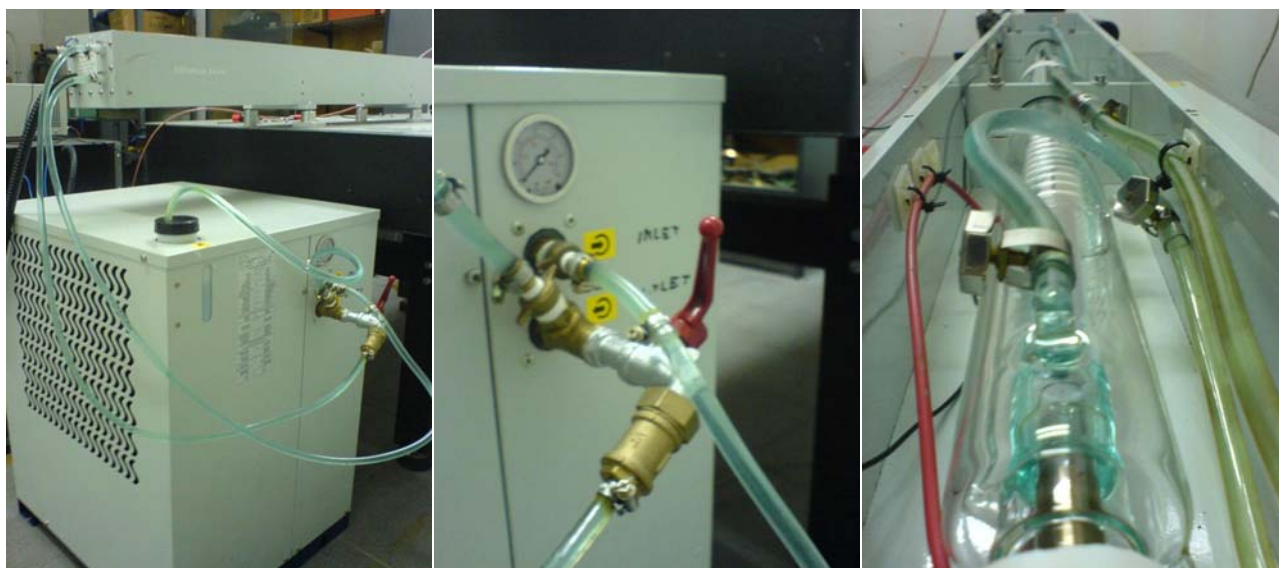
Εικόνα 7.7 Σύστημα υδρόψυξης του laser: α) κυκλοφορητής ΤΑΕ ενο M10 της MTA, β) σύστημα παράκαμψης του πλεονάζοντος ψυκτικού μείγματος και γ) άποψη του εσωτερικού του laser, στην οποία διακρίνεται εκτός των άλλων και το σύστημα σωληνώσεων για την κυκλοφορία του μείγματος
