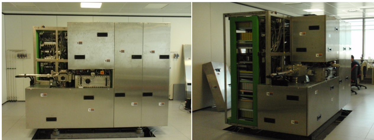
Εικόνα 2.2 Η διάταξη SIMS που χρησιμοποιήθηκε στις μετρήσεις στο ινστιτούτο FBK, τύπου Cameca Wf/Sc-ULTRA
