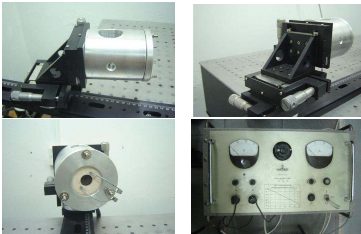
Εικόνα 7.3 α) πλάγια β) οπίσθια γ) εμπρόσθια άποψη της θερμαντικής βάσης που χρησιμοποιήθηκε. Διακρίνονται εκτός των άλλων το σπιδράλ νημάτιο, η κεραμική βάση στήριξης του και τα κλιπ που συγκρατούν το δείγμα και δ) το τροφοδοτικό τύπου Siemens.
