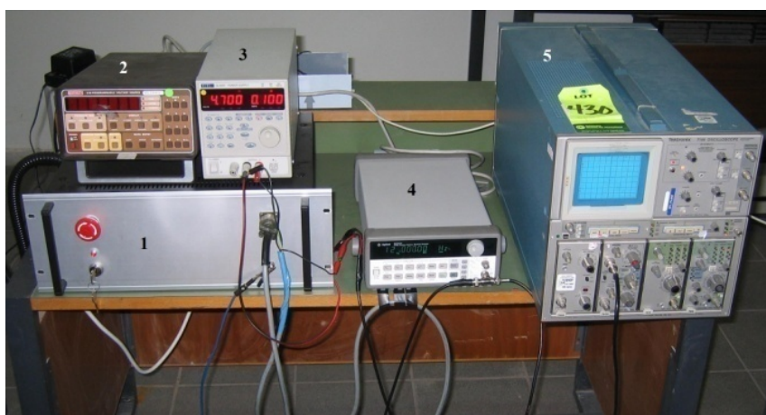
Εικόνα 7.4 Ηλεκτρονικές διατάξεις – παρελκόμενα του laser: 1. τροφοδοτικό 2. προγραμματιζόμενη γεννήτρια τάσης τύπου 230 της Keithley 3. προγραμματιζόμενο τροφοδοτικό τάσης tti QL355P, 4. γεννήτρια παλμών τύπου Agilent 33120A, 5. παλμογράφος
