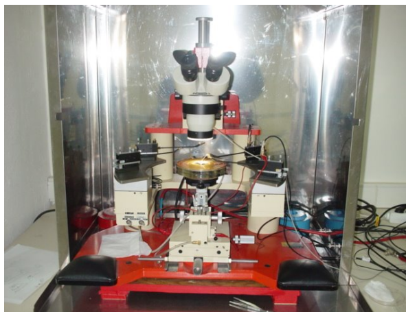
Εικόνα 2.3 Η διάταξη που χρησιμοποιήθηκε για την μέτρηση της επιφανειακής αντίστασης. Διακρίνονται οι τέσσερες ακίδες, η βάση στήριξης του δείγματος και το μικροσκόπιο που χρησιμοποιείται για την τοποθέτηση των ακίδων.
