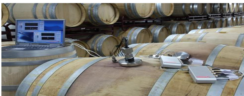
Εικόνα 14: Η εγκατάσταση μέτρησης οξυγόνου στα βαρέλια κρασιού
