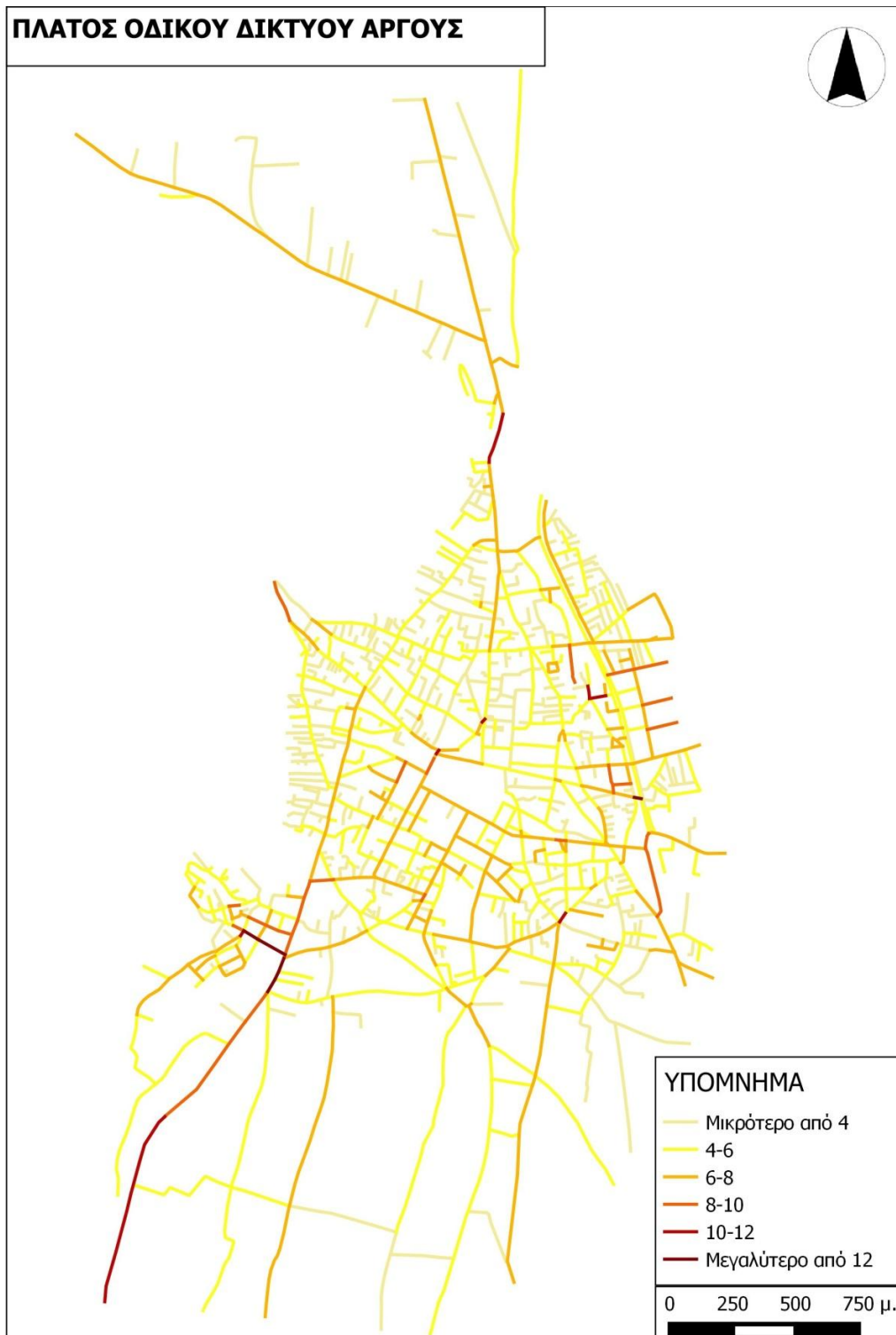
Εικόνα 39: Πλάτος οδοστρώματος, Πηγή: Ιδία επεξεργασία
