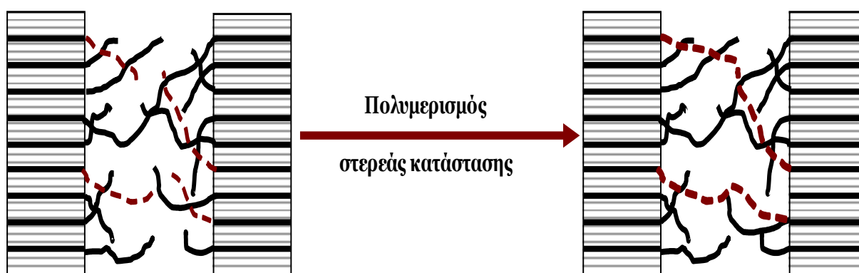
Σχήμα 2.4. Σχηματική απεικόνιση του «μοντέλου των δυο φάσεων» για την περίπτωση των πολυαμιδίων.
