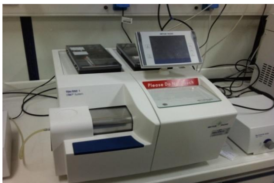
Σχήμα 9.4. Συσκευή θερμοσταθμικής ανάλυσης TGA/DSC 1 (Mettler Inc.) του Τομέα IV της Σχολής Χημικών Μηχανικών Ε.Μ.Π.
