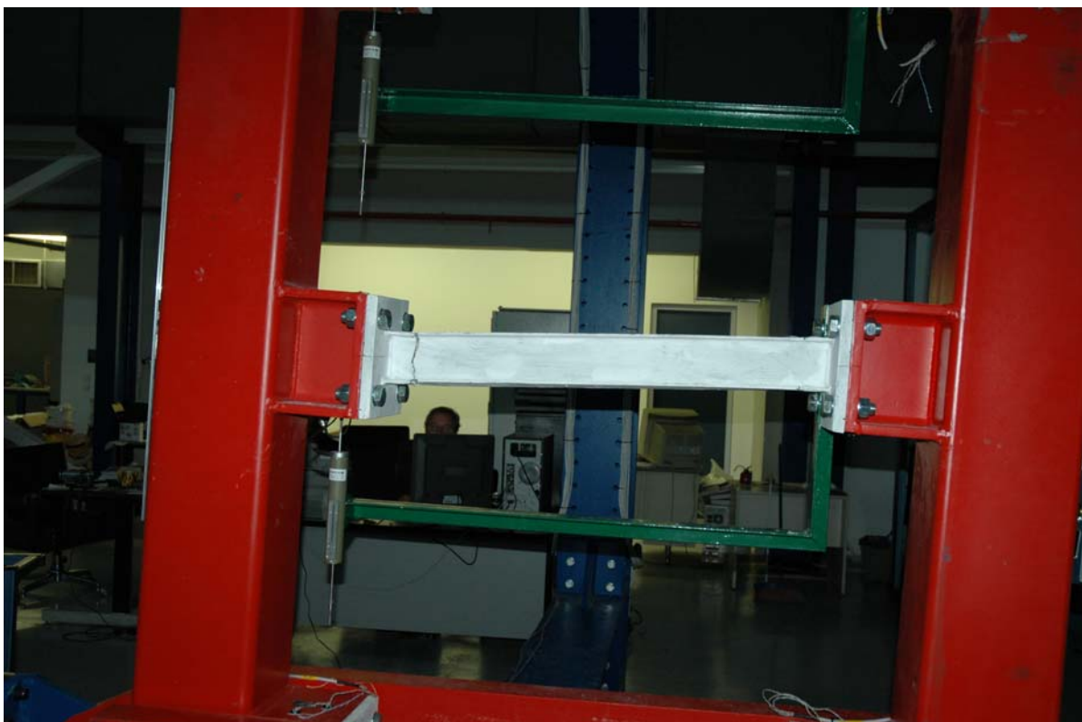
Φωτ. 5.2.3. Όψη δοκιμίου 1 IPE 100, με συνολική αστοχία (Πείραμα 5 IPE)
