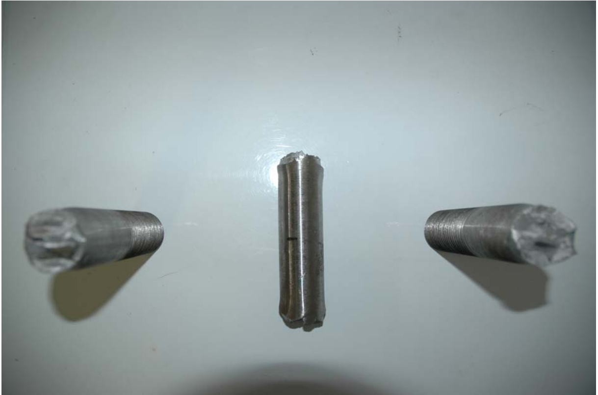
Φωτ. 5.12.6. . Όψη του δοκιμίου 1 ROD \Phi 33 double screw μετά την αστοχία
