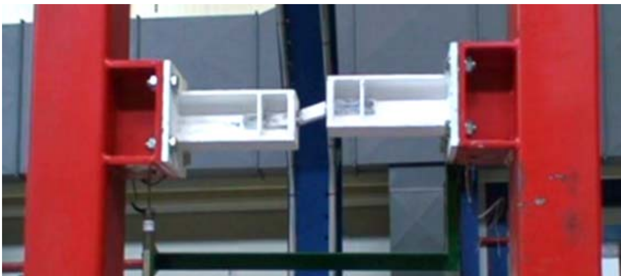
Φωτ. 5.4.3. Όψη του δοκιμίου σε προχωρημένη παραμόρφωση 1 bar 2*12/3080/5)
