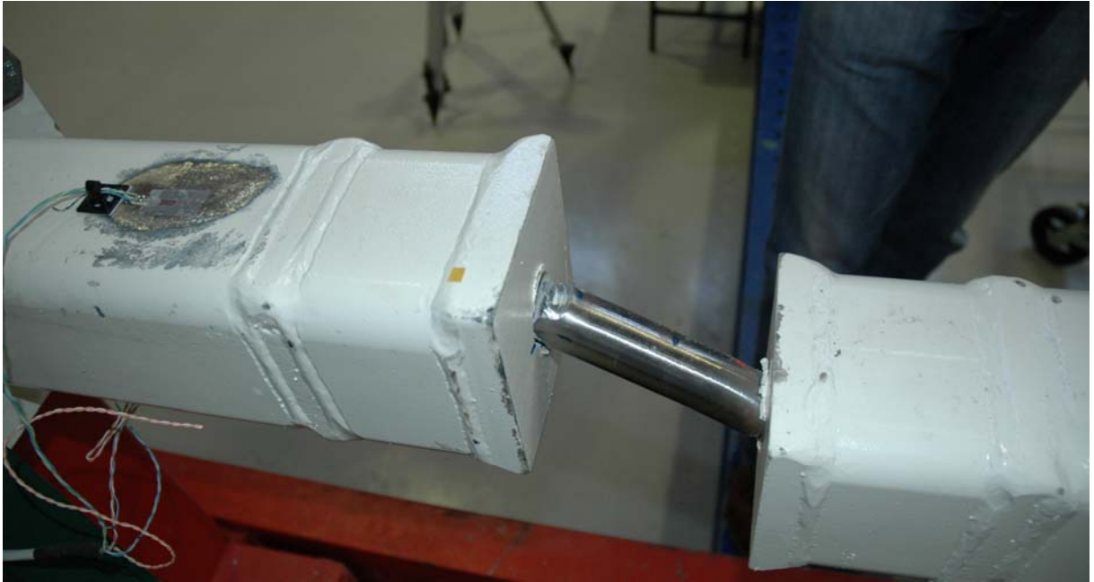
Φωτ. 5.11.7. Όψη του δοκιμίου 1 ROD \Phi 33 single screw προ της αστοχίας.
