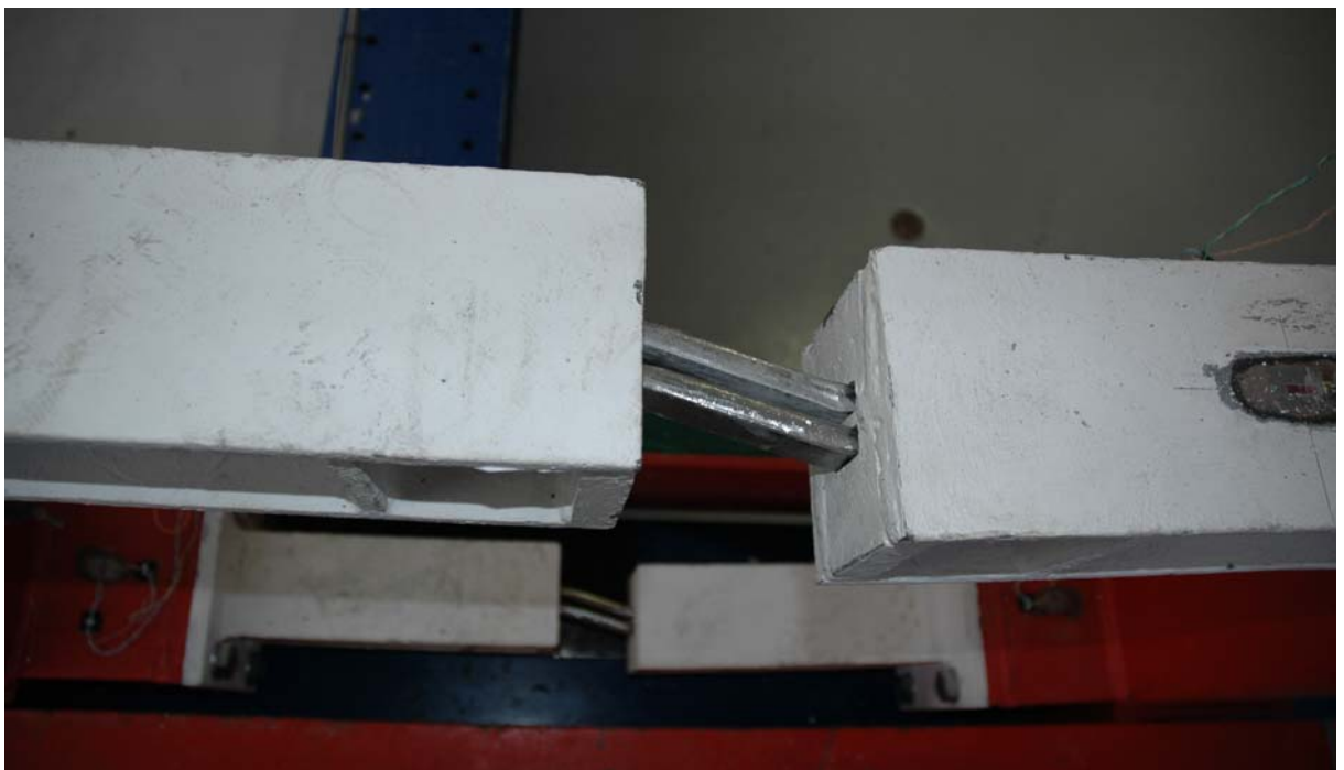
Φωτ. 5.5.9. Δοκίμιο τύπου INERD, κάτοψη, σε συνθήκες πλήρους αστοχίας (πείραμα 5* 2 bars 12/30)
