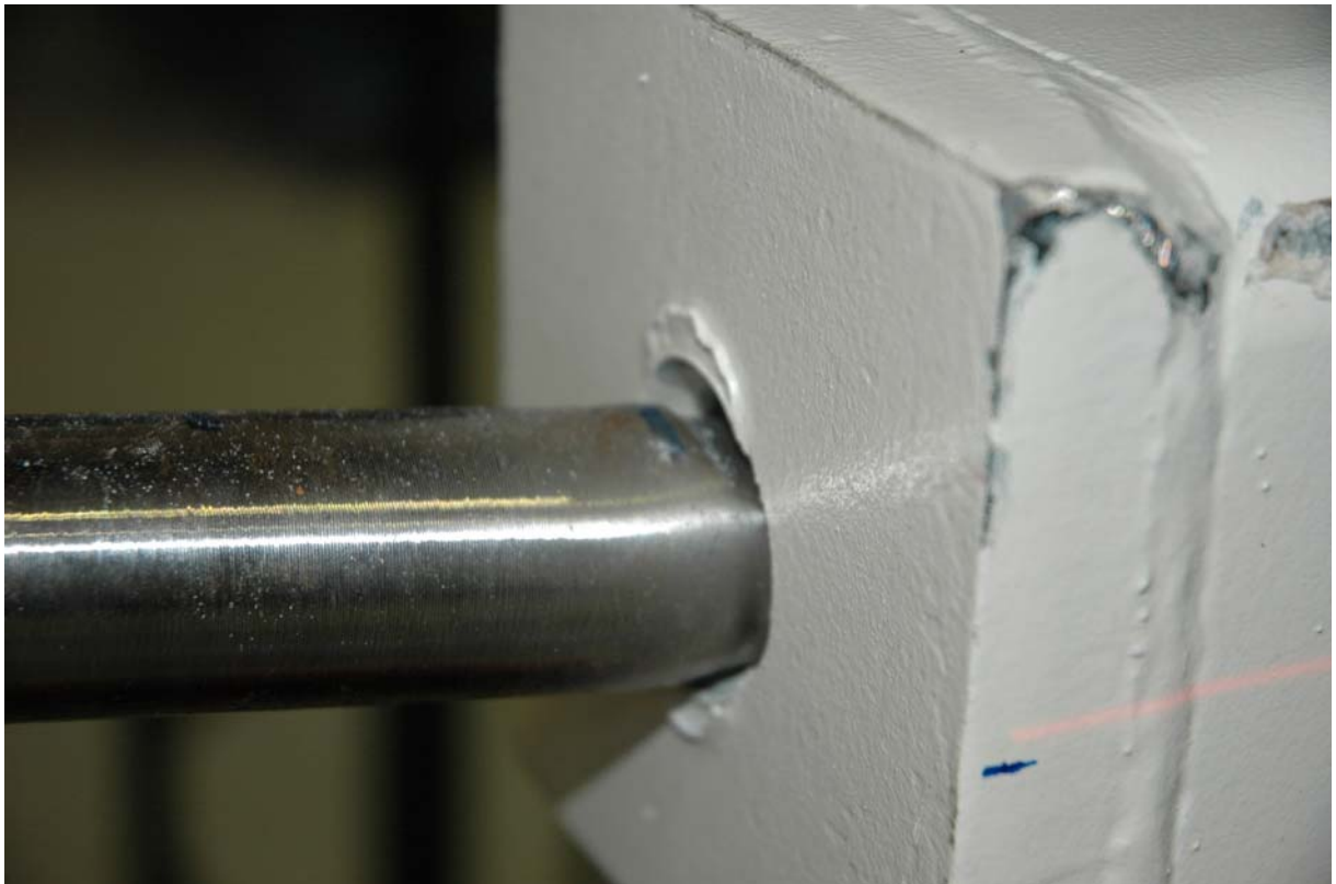
Φωτ. 5.11.5. Όψη του δοκιμίου 1 ROD \Phi 33 single screw σε προχωρημένη παραμόρφωση
