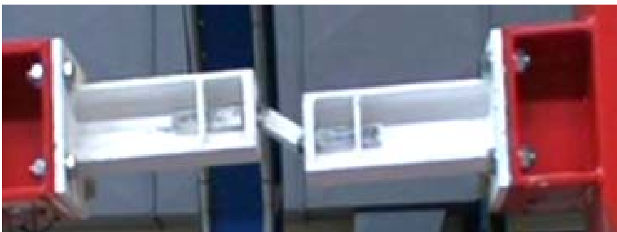
Φωτ. 5.4.5. . Όψη του δοκιμίου σε αστοχία 1 bar 2*12/3080/5)
