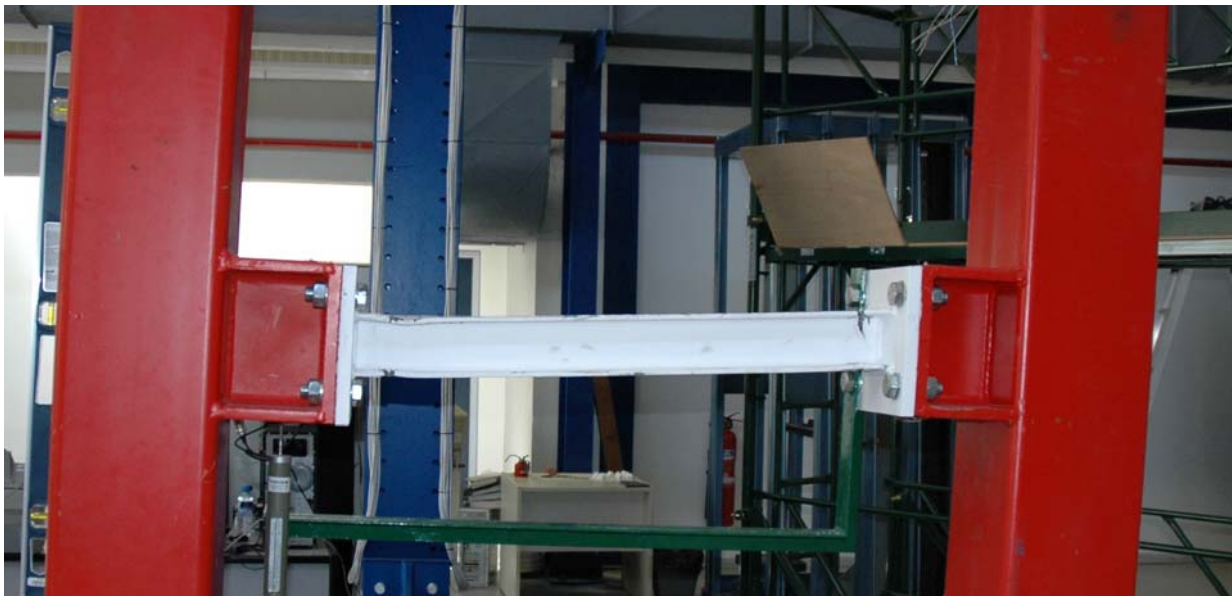
Φωτ. 5.7.2. Όψη του δοκιμίου 1 HE-A 100, σε προχωρημένη παραμόρφωση(Πείραμα 1 HE-A 100)
