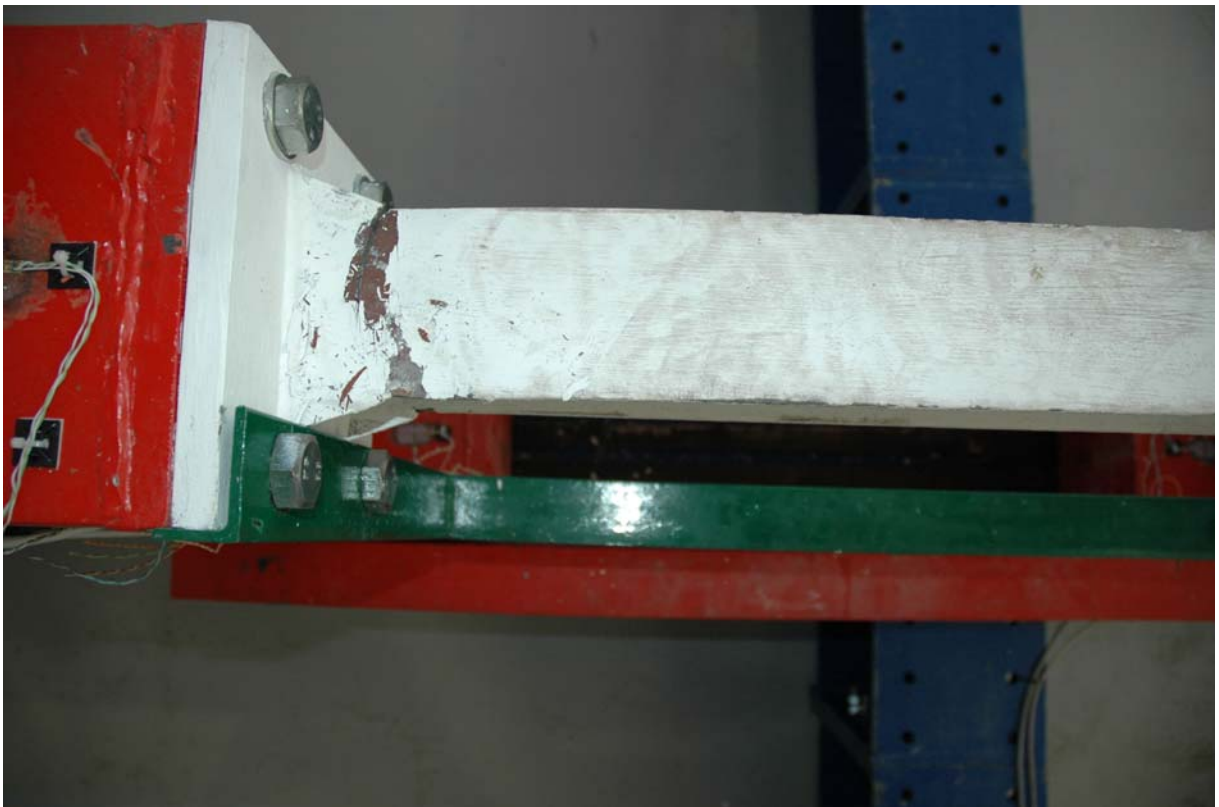
Φωτ. 5.7.5. Κάτοψη του δοκιμίου (λεπτομέρεια) σε συνθήκες πλήρους αστοχίας (πείραμα 1 HE-A 100)
