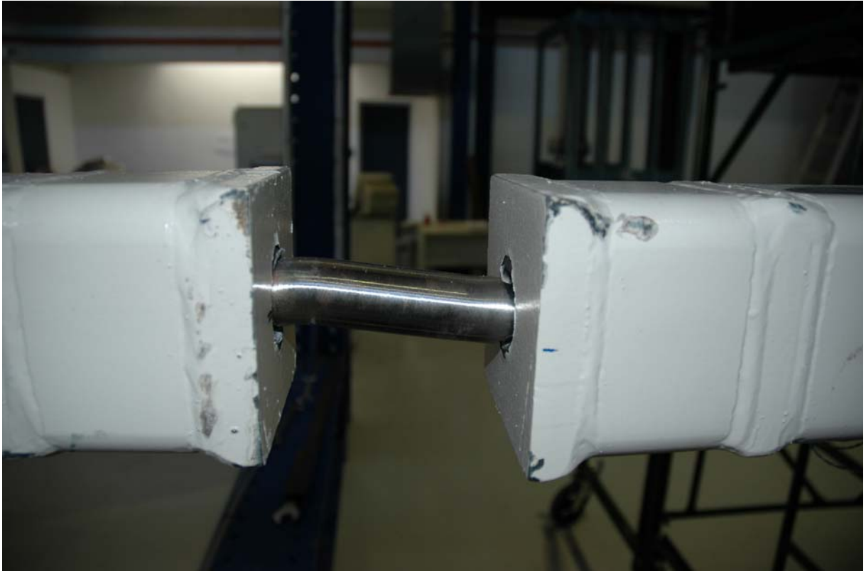
Φωτ. 5.14.4. Όψη του δοκιμίου 1 ROD Φ33 single screw σε προχωρημένη παραμόρφωση
