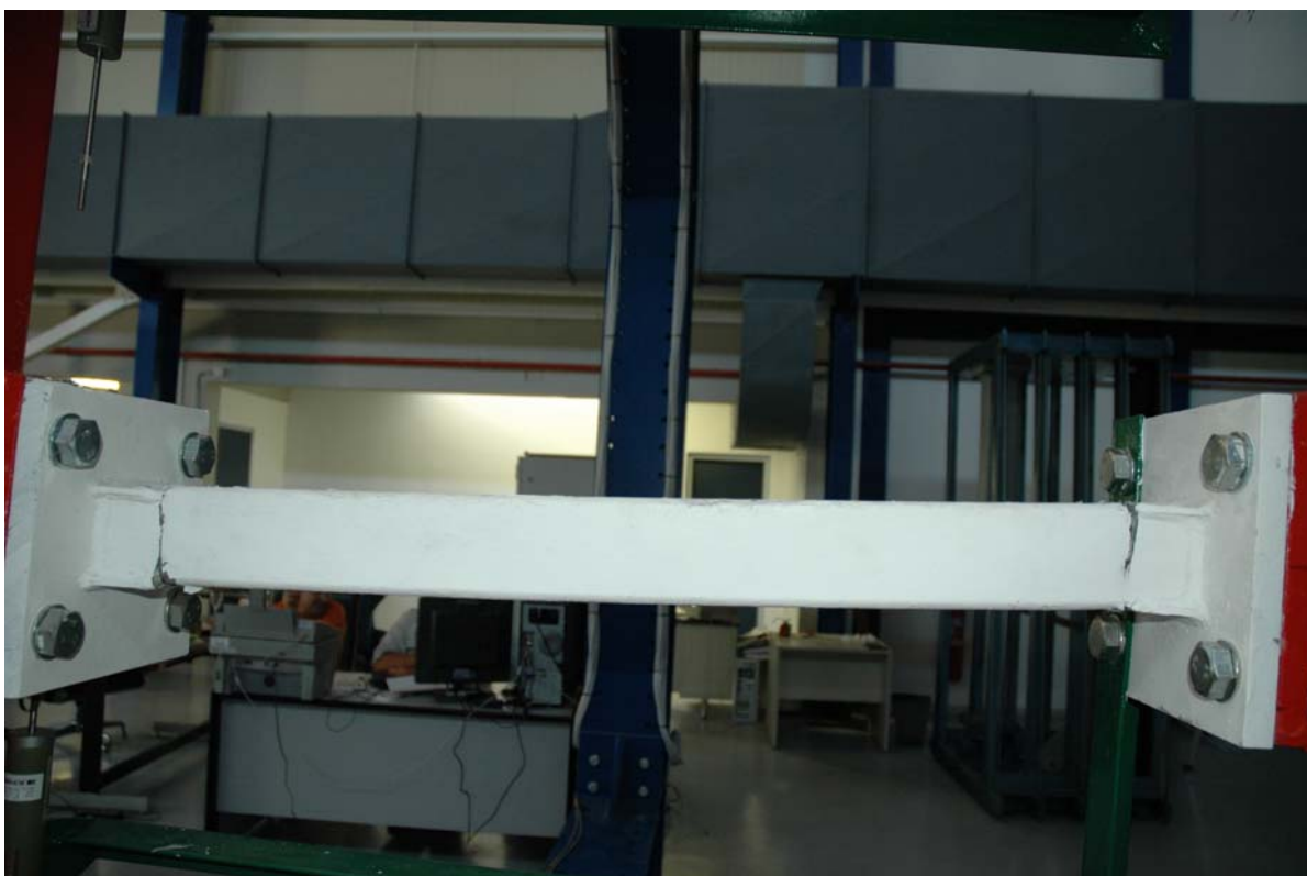
Φωτ. 5.3.3. Όψη του δοκιμίου 1 SHS 80/5, με συνολική αστοχία (Πείραμα 5 SHS 80/5)
