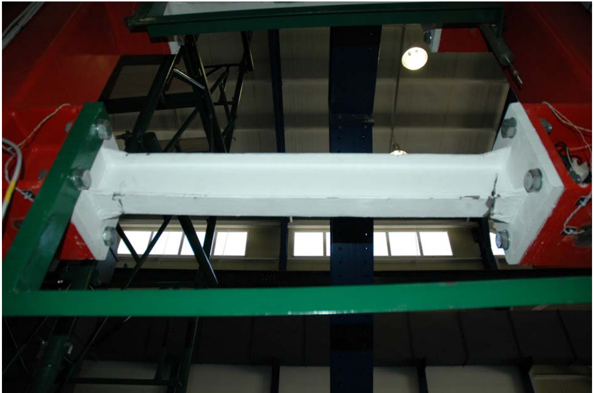
Φωτ. 5.8.4. Όψη του δοκίμιου 1 IPE 120, με συνολική αστοχία (Πείραμα 5 IPE 80-160)
