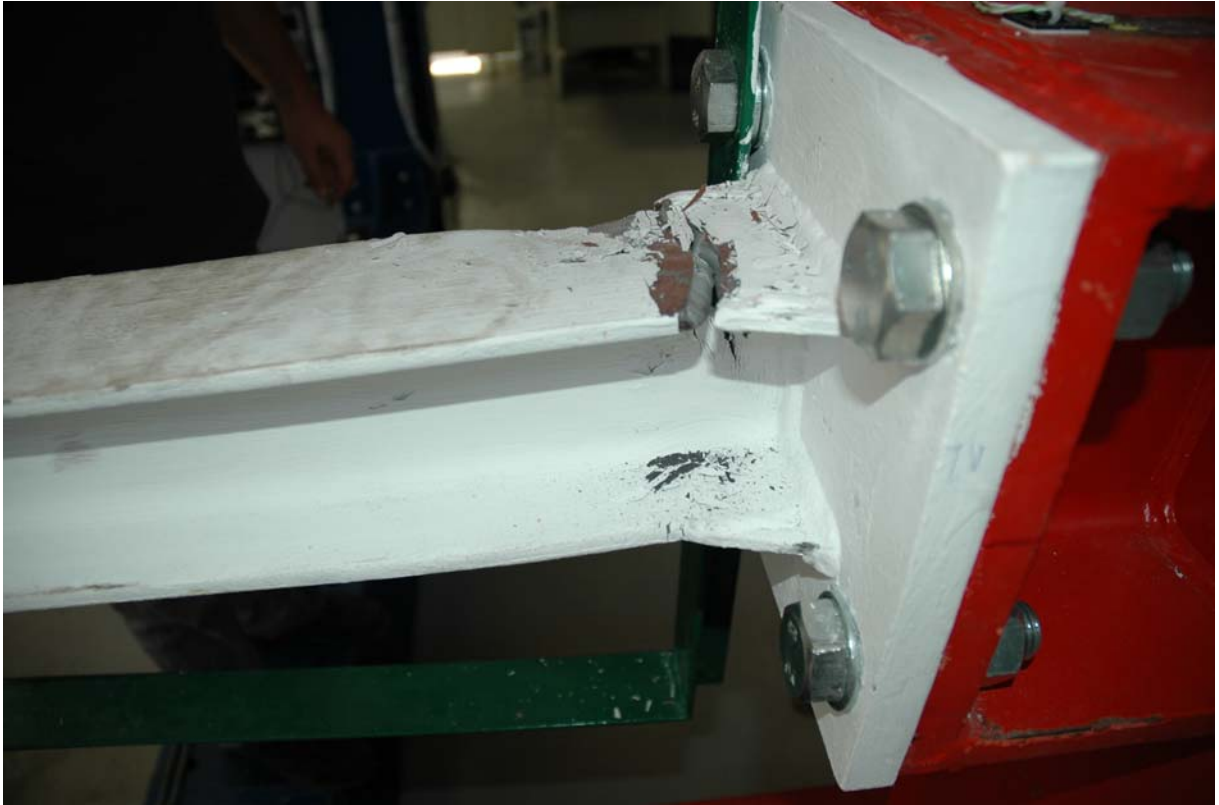
Φωτ. 5.7.4. Όψη δοκιμίου σε συνθήκες πλήρους αστοχίας (πείραμα 1 HE-A 100)
