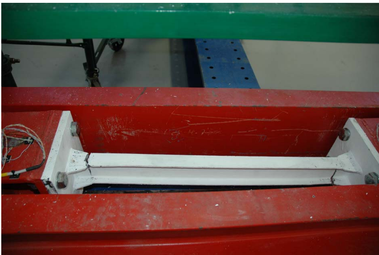
Φωτ. 5.8.3. Κάτοψη του δοκιμίου 1 IPE 80, με συνολική αστοχία (Πείραμα 5 IPE 80-160)
