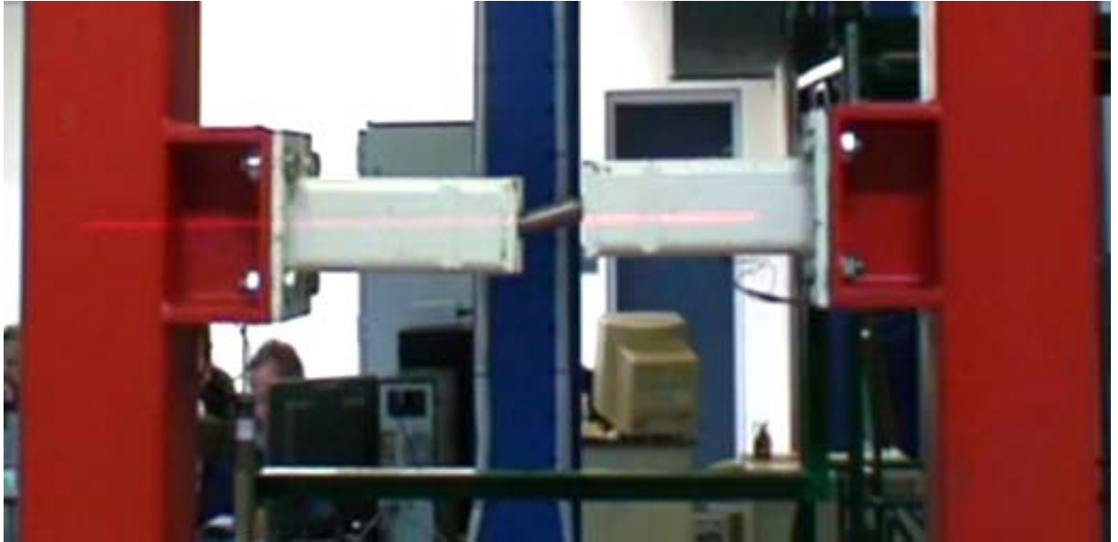
Φωτ. 5.15.3. Όψη του δοκιμίου 1 ROD \Phi 33 single screw - Ringslots σε προχωρημένη παραμόρφωση.
