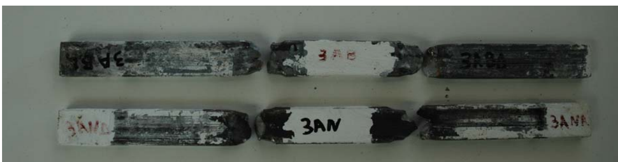
Φωτ. 5.5.7. Οι ράβδοι τύπου INERD μετά την πλήρη αστοχία (πείραμα 5* 2 bars 12/30)
