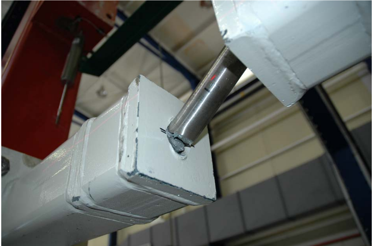
Φωτ. 5.12.4. Όψη του δοκιμίου 1 ROD \Phi 33 double screw σε αστοχία
