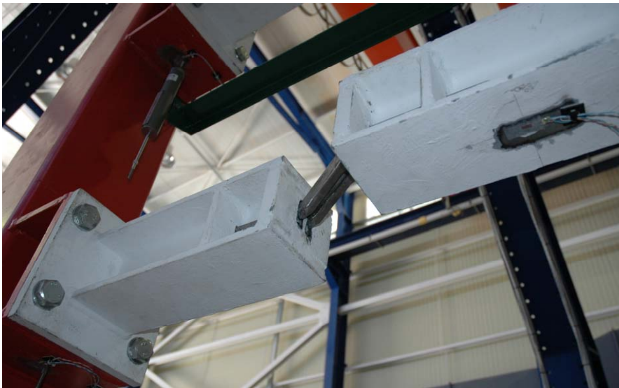
Φωτ. 5.5.5 Δοκίμιο (λεπτομέρεια) σε συνθήκες πλήρους αστοχίας (πείραμα 5 * 2 bars 12/30)
