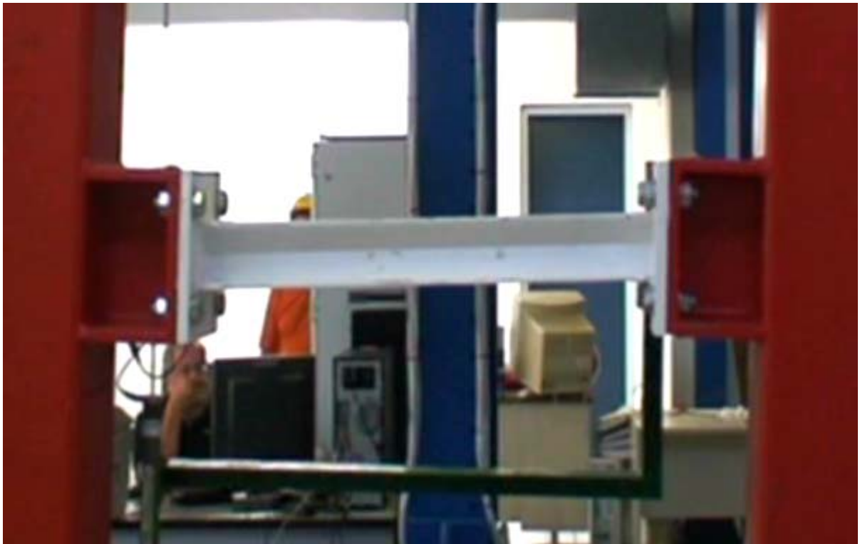
Φωτ. 5.6.4. Όψη δοκιμίου σε προχωρημένη παραμόρφωση (πείραμα 5 HE-A 100)
