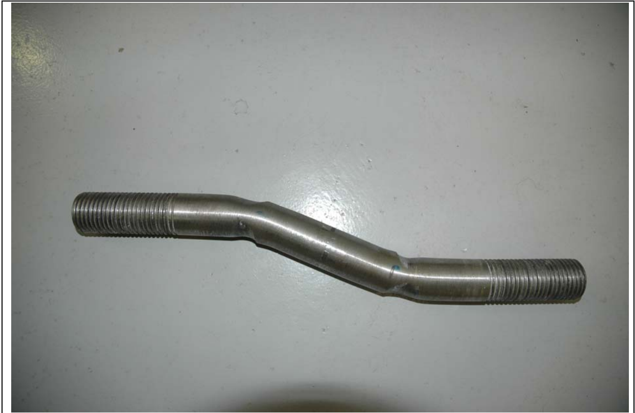
Φωτ. 5.13.5. Όψη του δοκιμίου 1 ROD Φ33 single screw impact σε τελική παραμόρφωση
