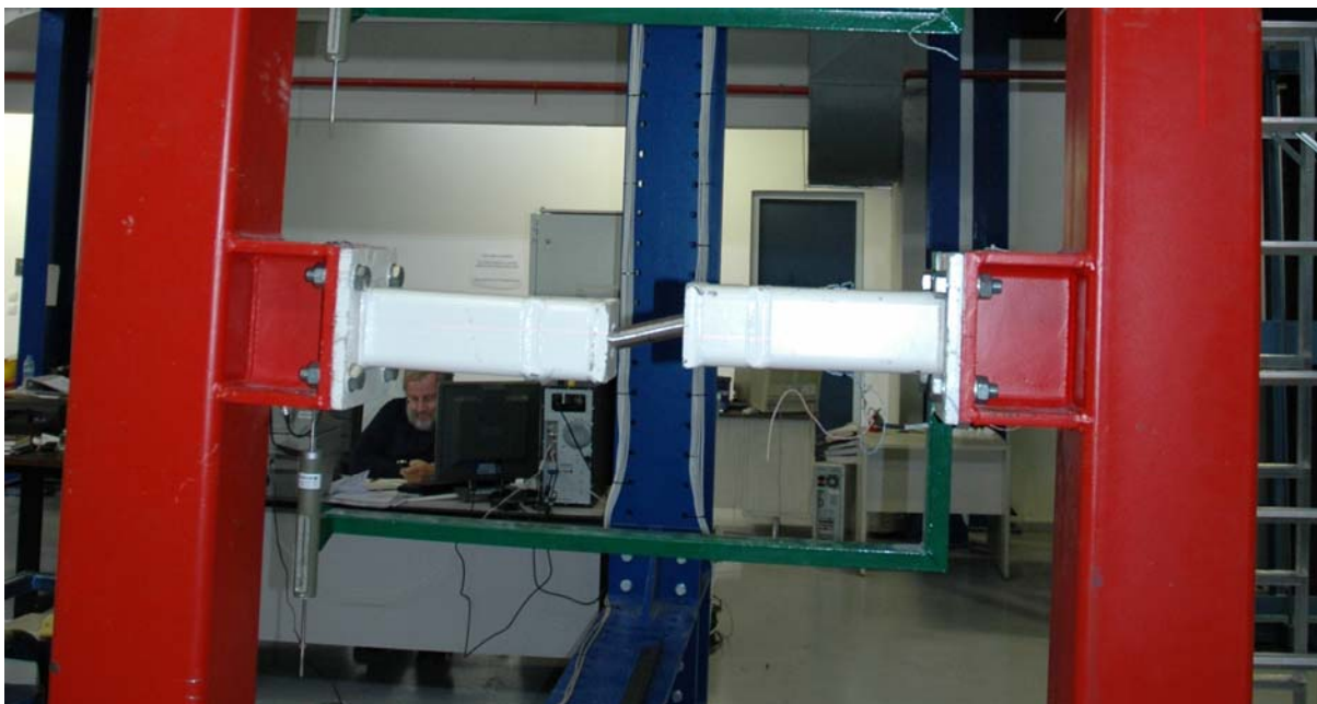
Φωτ. 5.12.2. Όψη του δοκιμίου 1 ROD Φ33 double screw σε προχωρημένη παραμόρφωση.
