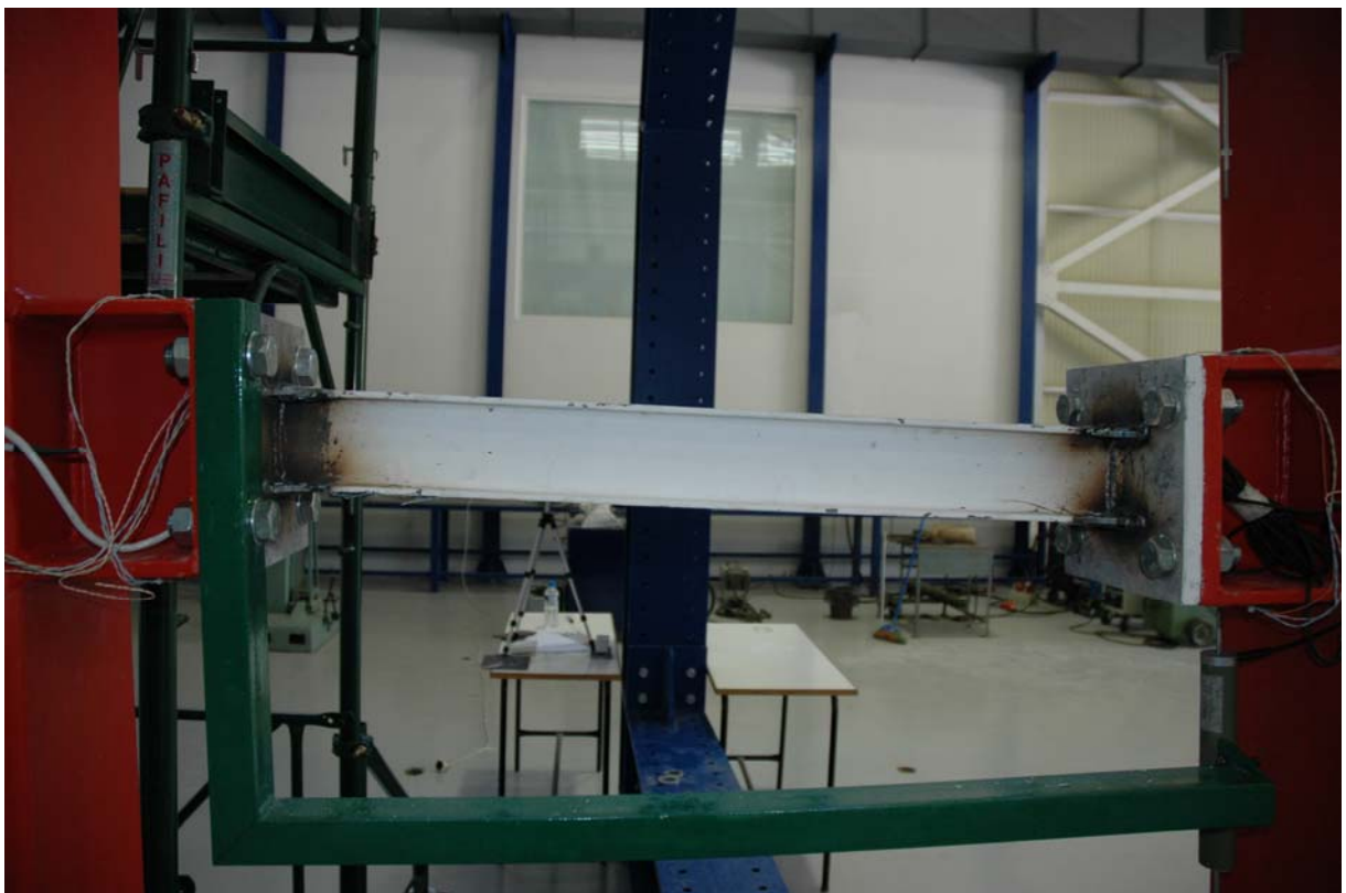
Φωτ. 5.8.5. Όψη του δοκίμιου 1 IPE 100, με συνολική αστοχία (Πείραμα 5 IPE 80-160))
