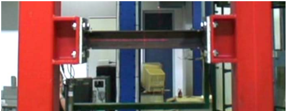
Φωτ. 5.10.2. Γενική διάταξη του πλαισίου δοκιμών του συστήματος INSTED (5 HE-A 100 Dogbones)
