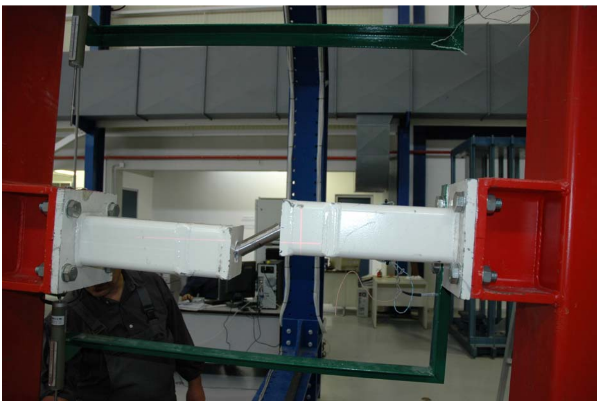
Φωτ. 5.12.3. Όψη του δοκιμίου 1 ROD Φ33 double screw σε προχωρημένη παραμόρφωση.
