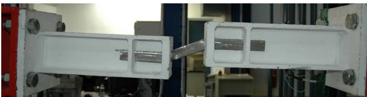
Φωτ. 5.5.6. Όψη του δοκιμίου (λεπτομέρεια) σε συνθήκες πλήρους αστοχίας (πείραμα 5* 2 bars 12/30)
