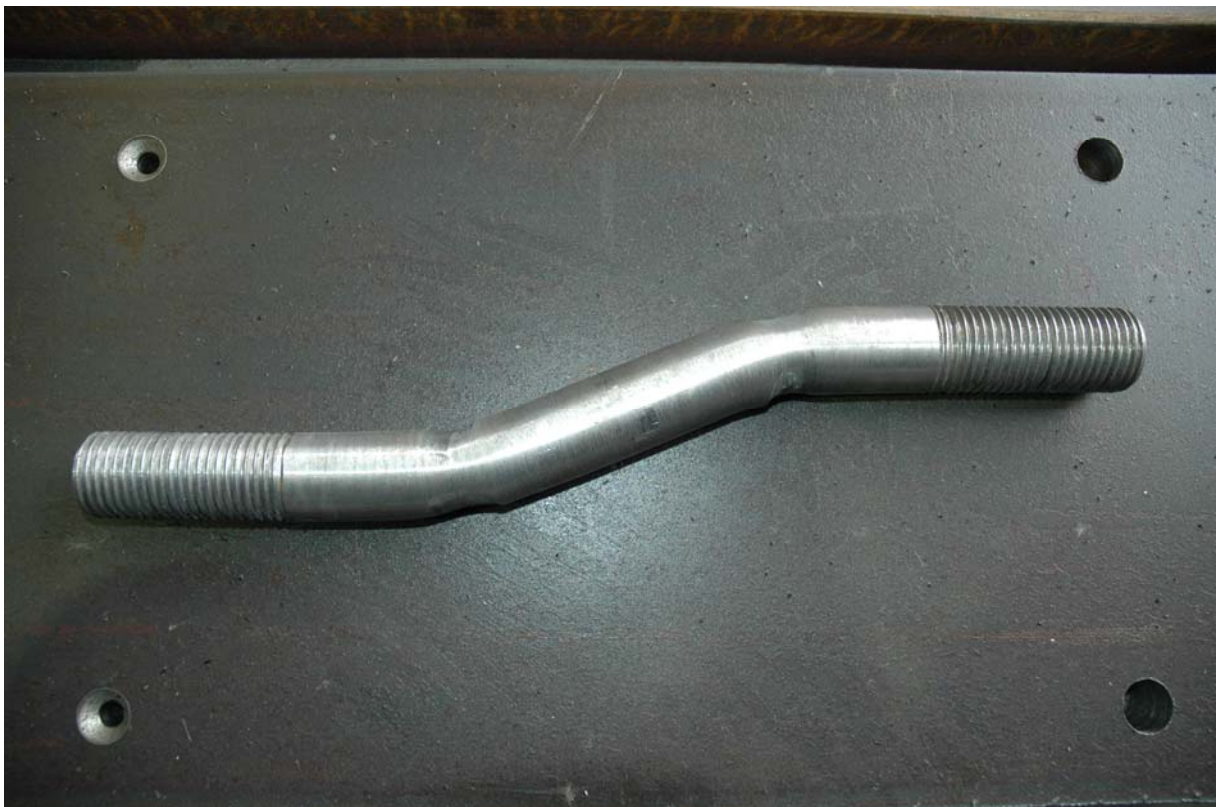
Φωτ. 5.13.6. . Όψη του δοκιμίου 1 ROD Φ33 double screw σε τελική παραμόρφωση
