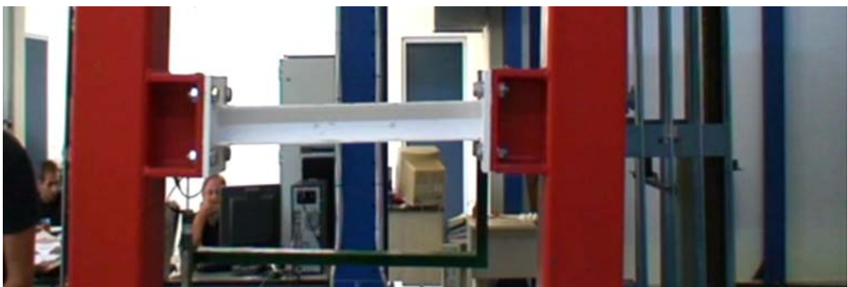
Φωτ. 5.6.2. Όψη του δοκιμίου 1 HE-A 100, σε παραμορφωμένη κατάσταση (Πείραμα 5 HE-A 100)
