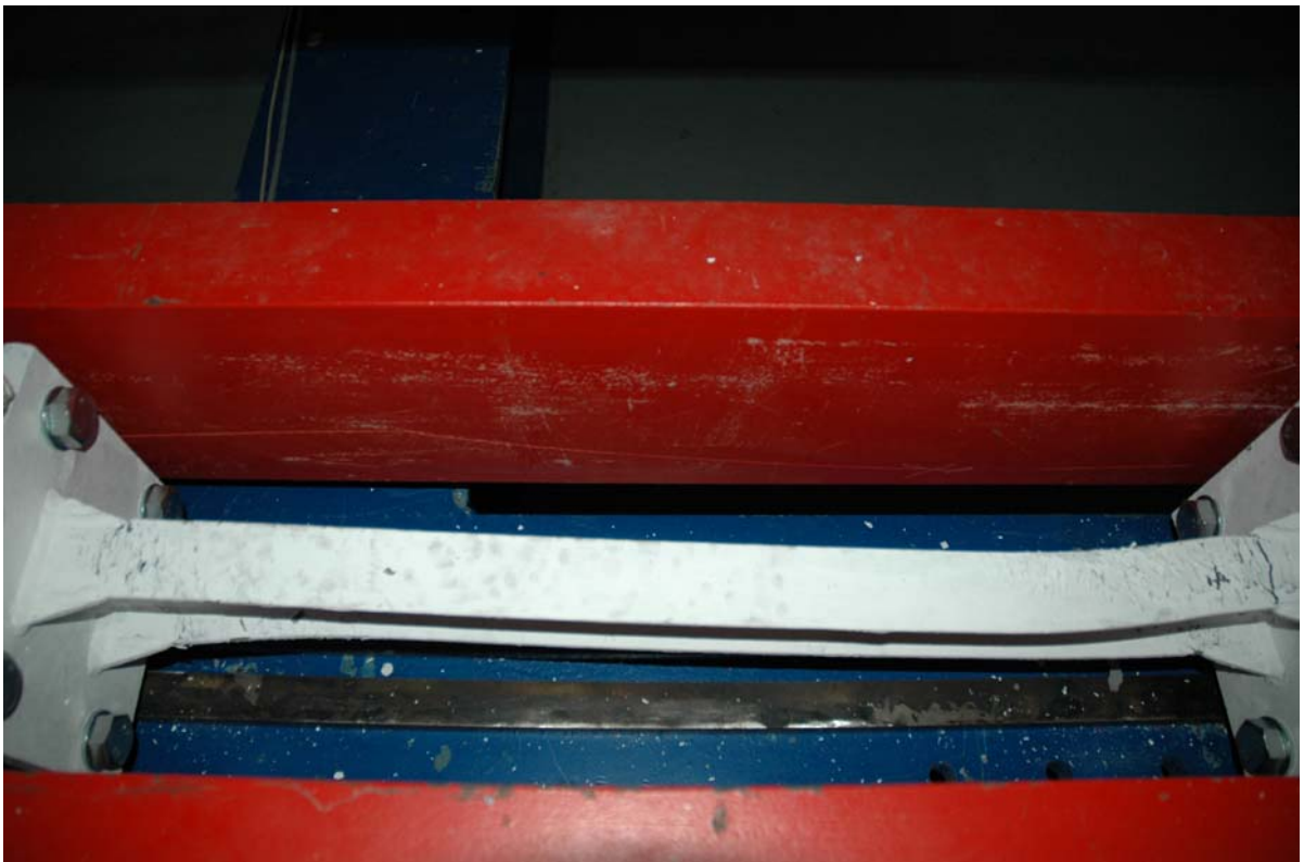
Φωτ. 5.2.8. Κάτοψη δοκιμίου σε συνθήκες πλήρους αστοχίας (πείραμα 5 IPE 100)
