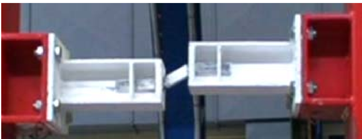
Φωτ. 5.4.4. Όψη του δοκιμίου στην έναρξη της αστοχίας 1 bar 2*12/3080/5)
