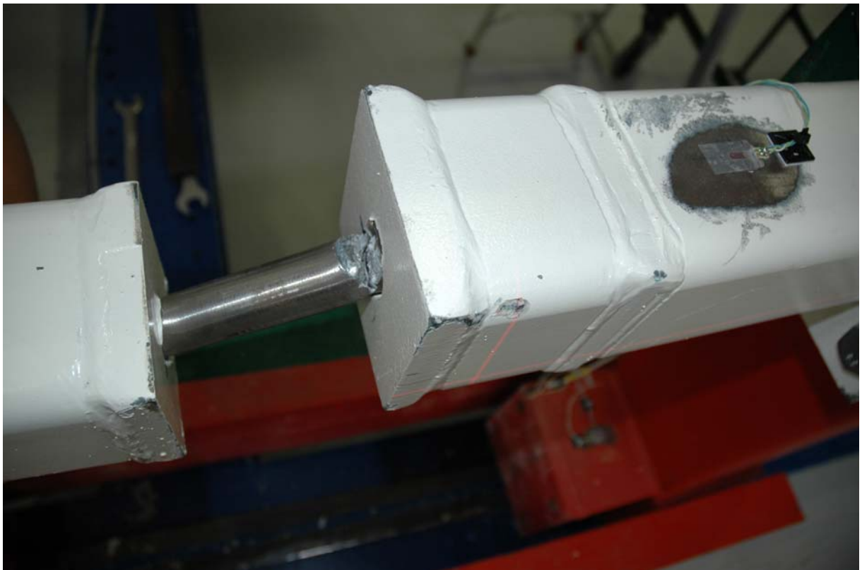
Φωτ. 5.12.5. Όψη του δοκιμίου 1 ROD \Phi 33 single screw σε προχωρημένη παραμόρφωση
