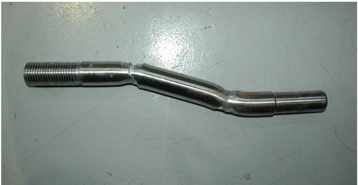
Φωτ. 5.11.6. . Όψη του δοκιμίου 1 ROD \Phi 33 single screw μετά την ολοκλήρωση του πειράματος
