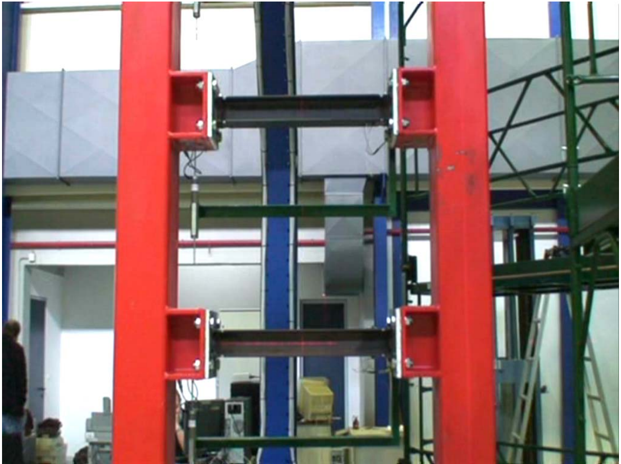
Φωτ. 5.10.1. Όψη της κατακόρυφης Vierendeel (διάταξη του συστήματος INSTED) Πείραμα 5 HE-A 100 Dogbones
