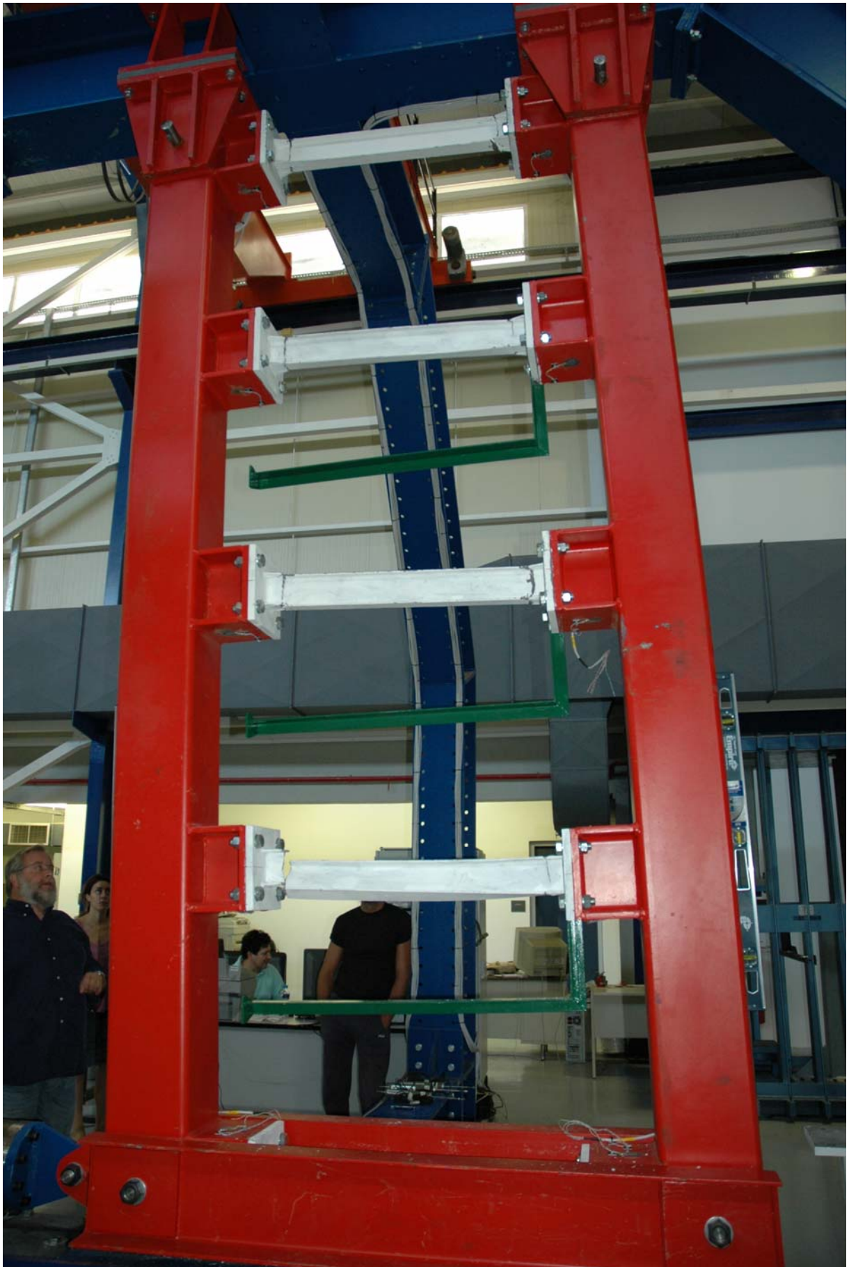
Φωτ. 5.2.4. . Όψη της κατακόρυφης Vierendeel σε συνθήκες πλήρους αστοχίας (πείραμα 5 IPE 100)
