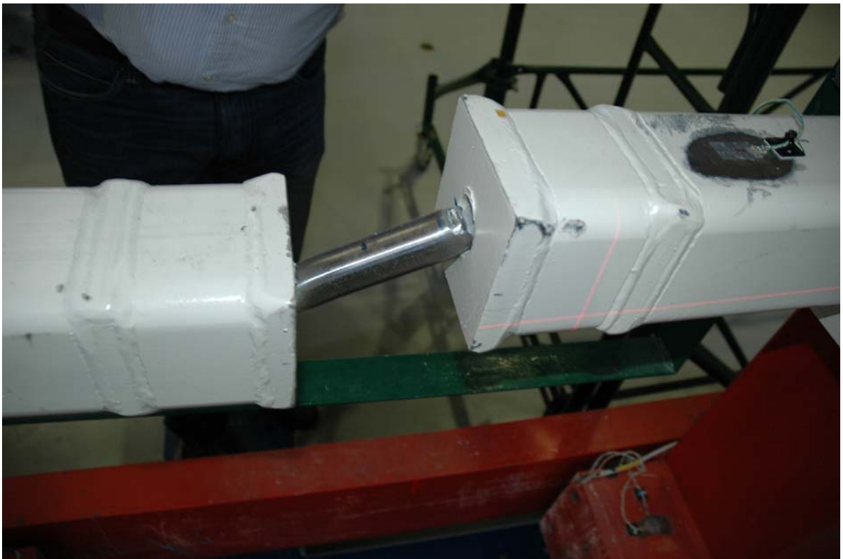
Φωτ. 5.11.8. Όψη του δοκιμίου 1 ROD \Phi 33 single screw προ της αστοχίας. Είναι εμφανής η επίδραση του τοπικού τραυματισμού από την επιφάνεια έδρασης.
