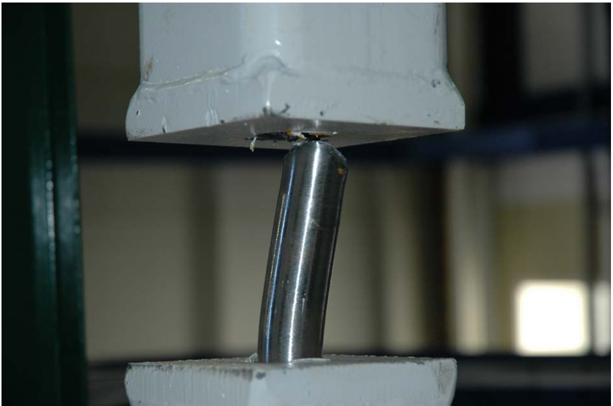
Φωτ. 5.11.5. Όψη του δοκιμίου 1 ROD Φ33 single screw σε αστοχία
