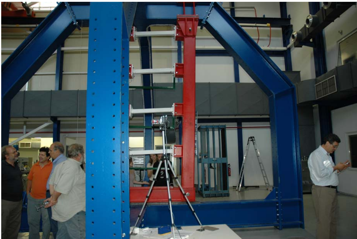
Φωτ. 5.3.2. Γενική διάταξη του πειράματος (πλαίσιο δοκιμών, συσκευή INSTED, δοκίμια 5 SHS 80/5)
