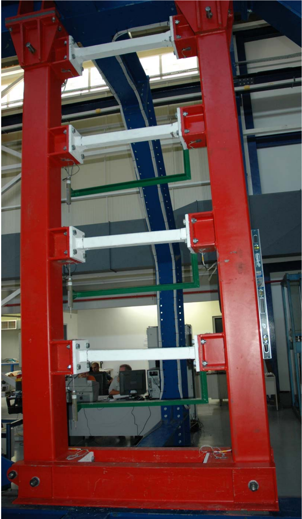
Φωτ. 5.3.1. Όψη της κατακόρυφης Vierendeel (διάταξη του συστήματος INSTED) 5 SHS 80/5
