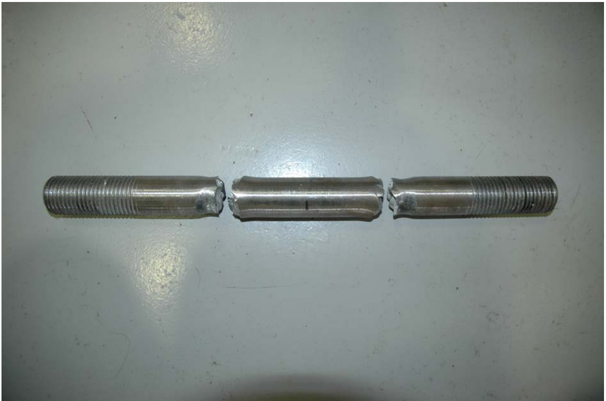
Φωτ. 5.12.7. . Όψη του δοκιμίου 1 ROD \Phi 33 double screw μετά την αστοχία.
