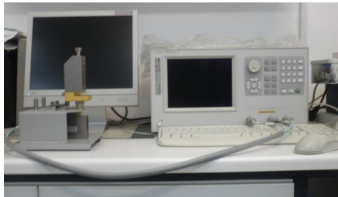
Εικόνα 4.8: Ολόκληρη η διάταξη μέτρησης των διηλεκτρικών μεγεθών στις υψηλές συχνότητες.
