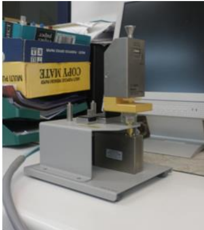
Εικόνα 4.7: Το κελί διηλεκτρικών μετρήσεων για τις υψηλές συχνότητες.
