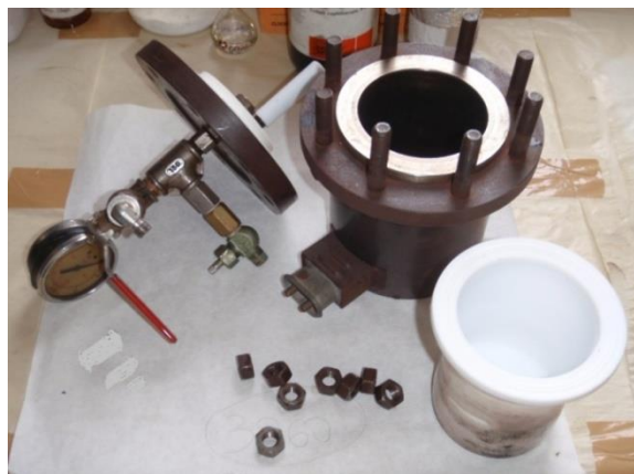
Εικόνα 7.10 Αυτόκλειστο Δοχείο κυλινδρικού σχήματος.
