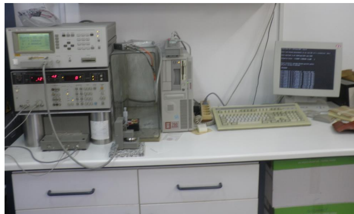
Εικόνα 4.5: Ολόκληρη η διάταξη μέτρησης των διηλεκτρικών μεγεθών στις χαμηλές συχνότητες 20 Hz-1 MHz
