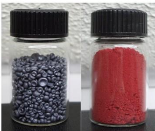
Εικόνα 6.10: Σελήνιο: μαύρη, υαλώδης χάντρα (αριστερά), κόκκινη σκόνη (δεξιά)
