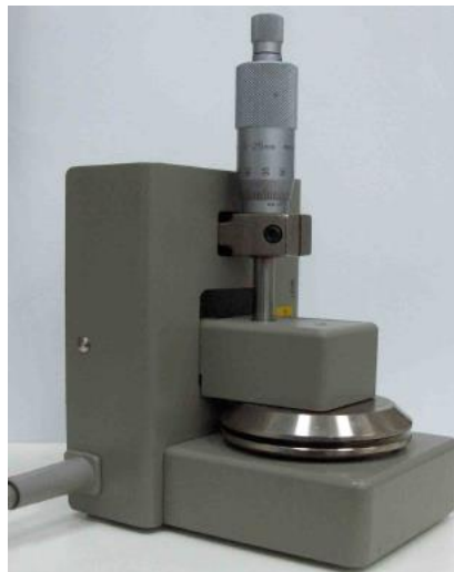
Εικόνα 4.4: Το κελί μετρήσεων
