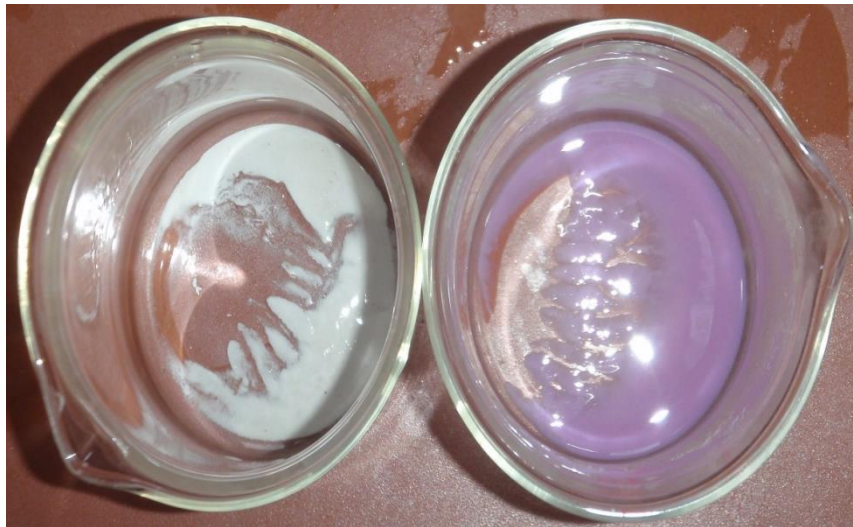
Εικόνα 7.29: Διάλυμα με ίζημα μετά το αυτόκλειστο
