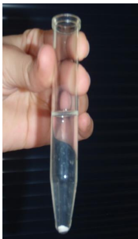
Εικόνα 7.28: Δοκιμαστικός σωλήνας με δύο φάσεις μετά από φυγοκέντρηση
