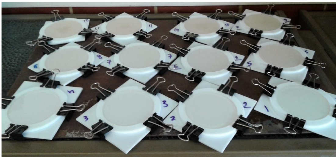
Εικόνα 6.1: Παραχθέντα δοκίμια (1-4 καθαρή ρητίνη, 5-8 Ρητίνη και 0,5% ZnO, 9-12 Ρητίνη και 2% ZnO).
