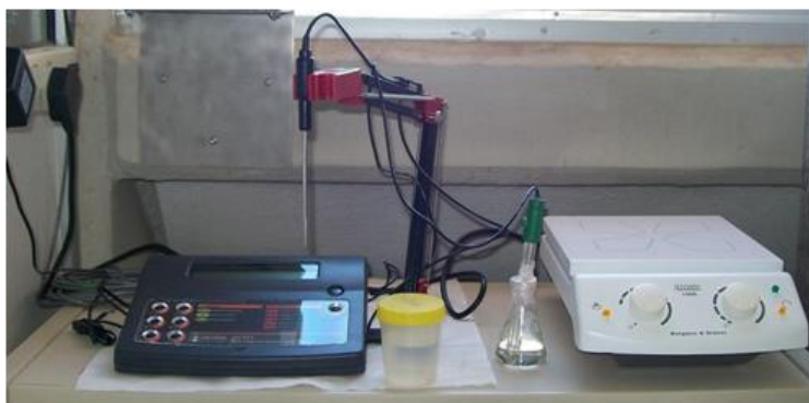
Εικόνα 7.26: Ειδική διάταξη για την μέτρηση και ρύθμιση του pH του ηλεκτρολυτικού διαλύματος
