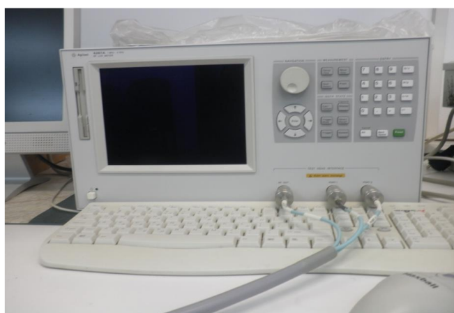
Εικόνα 4.6: Γέφυρα υψηλών συχνοτήτων.
