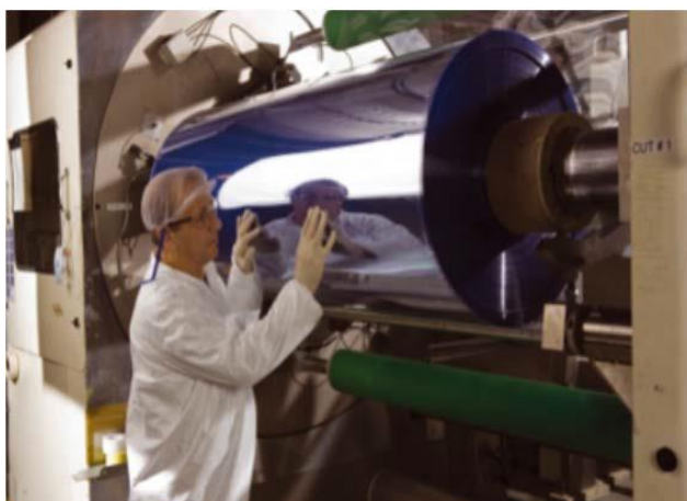
Εικόνα 4.7: Κατασκευή οργανικών-πολυμερών φωτοβολταϊκών μέσω διαδικασίας τύπου roll to roll.
