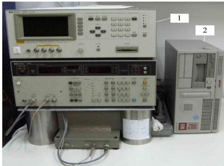
Εικόνα 4.3 Η γέφυρα LCR (1) και ο Η/Υ (2) για τον έλεγχο της
