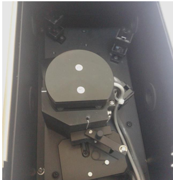
Εικόνα 7.21: Εσωτερική άποψη της σφαίρας ολοκλήρωσης σε φωτογραφία
