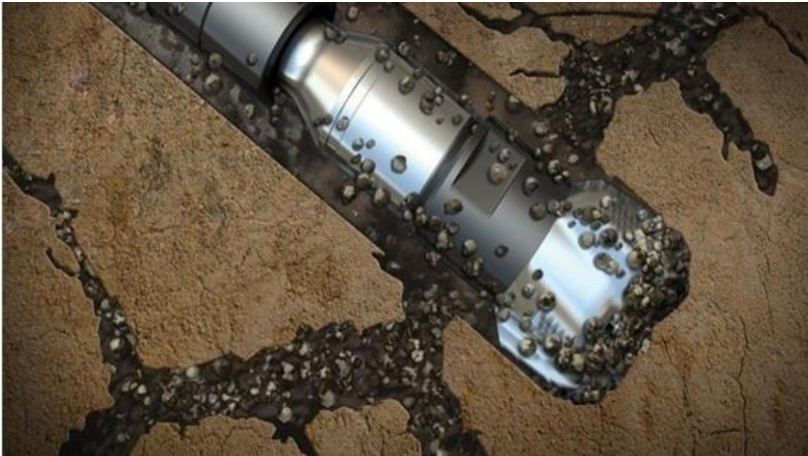
Σχήμα (2.4) : Απώλεια λάσπης διάτρησης στο περιβάλλον πέτρωμα
