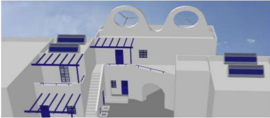
Εικόνα 3.28: Ενσωμάτωση μπλε ηλιακών συλλεκτών σε κτίριο των Κυκλάδων [3.27]
