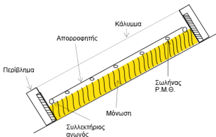
Εικόνα 3.20: Τομή επίπεδου ηλιακού συλλέκτη [3.21]
