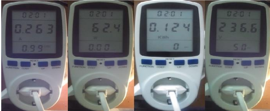
Εικόνα 7.2 Μετρήσεις energy meter με το τέλος των μετρήσεων (από αριστερά προς τα δεξιά: ρεύμα, ισχύς, κατανάλωση και τάση)
