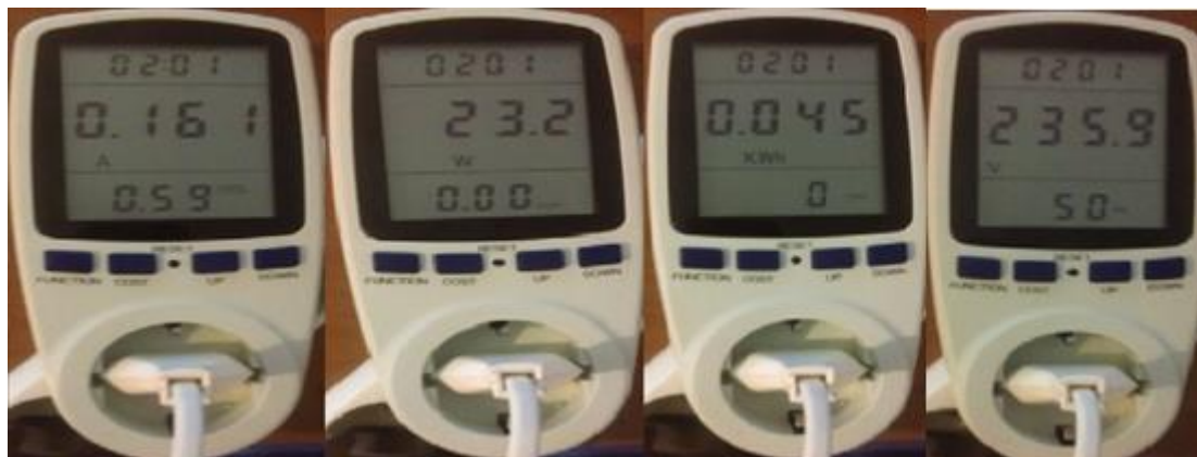
Εικόνα 7.4 Μετρήσεις energy meter με το τέλος των μετρήσεων (από αριστερά προς τα δεξιά: ρεύμα και συντελεστής ισχύος, ισχύς, κατανάλωση και τάση)
