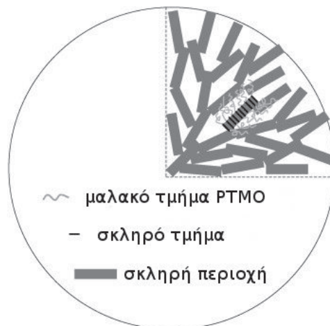
Σχήμα 1.8: Εσωτερική δομή ενός κρυσταλλίτη. Μεταφρασμένο από το [110].
