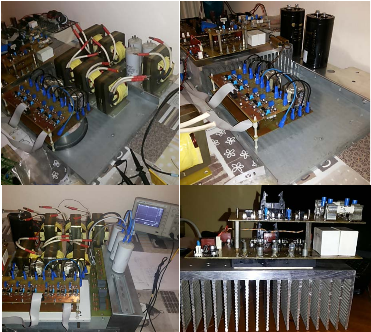
Σχήμα Α-15: Φωτογραφίες διάταξης κατά την διαδικασία κατασκευής και δοκιμής.
