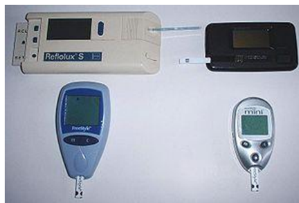
Εικόνα 2.3: Τέσσερις γενιές συμβατικών διατάξεων μέτρησης γλυκόζης αίματος (1993-2005). Το μέγεθος των δειγμάτων μειώνεται από 30 \mu\text{l} σε 0.3 \mu\text{l} . Ο χρόνος υπολογισμού της συγκέντρωσης γλυκόζης μειώνεται από 2 λεπτά σε 5 δευτερόλεπτα. Ο χρόνος υπολογισμού στις σύγχρονες διατάξεις είναι χαμηλότερος από 15 δευτερόλεπτα [14]
