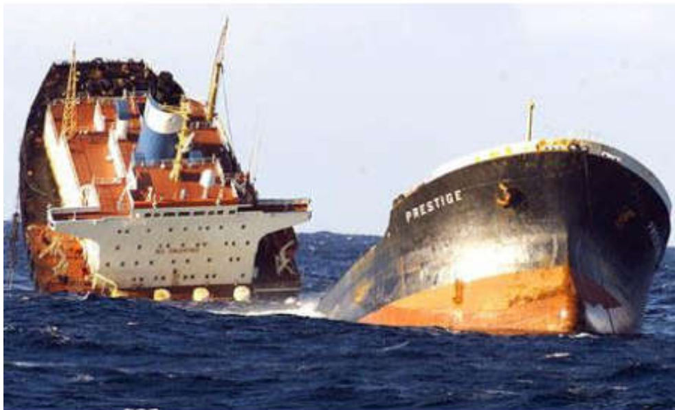
Σχήμα 1.2 Στη φωτογραφία φαίνεται η σταδιακή κατάρρευση της διατομής του πλοίου Prestige, που επήλθε μετά τον αρχικό λυγισμό του καταστρώματος και την επακόλουθη κατάκλυση του μεσαίου αμπαριού λόγω εισροής υδάτων [10].
