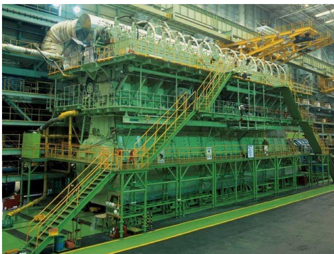
Σχήμα 4.3: Φωτογραφίες του ισχυρότερου σήμερα κινητήρα Diesel αριστερα και του στοβιλο-υπερπληρωτή που χρησιμοποιεί, δεξιά
