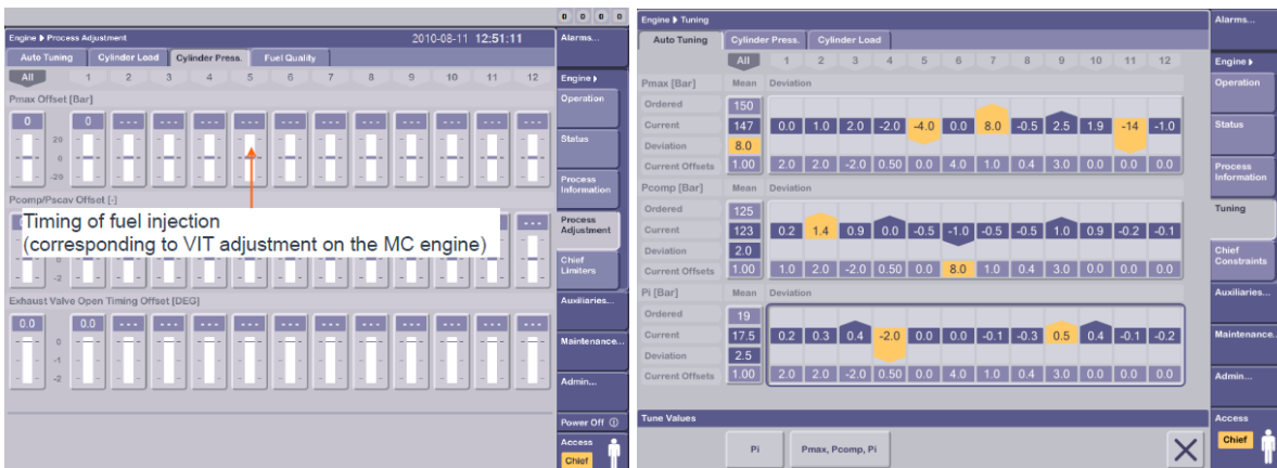
Σχήμα 4.7: Ρύθμιση παραμέτρων λειτουργίας ηλεκτρονικού κινητήρα
