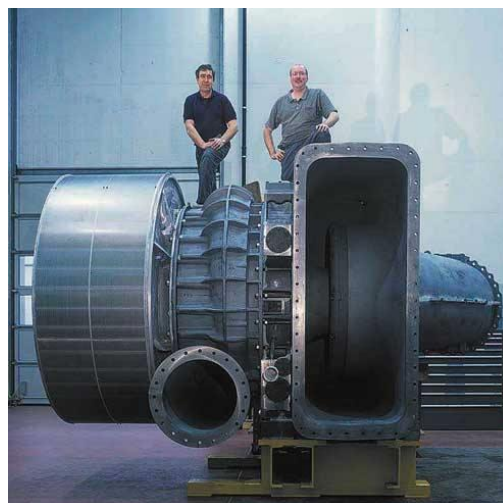
Σχήμα 4.3: Φωτογραφίες του ισχυρότερου σήμερα κινητήρα Diesel αριστερα και του στοβιλο-υπερπληρωτή που χρησιμοποιεί, δεξιά
