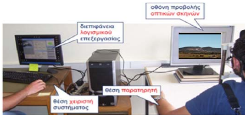
Εικόνα 52. Γεωμετρική διάταξη του συστήματος χειριστής – παρατηρητής – σύστημα καταγραφής – ακινητοποιητής κεφαλής (chinrest) (Πηγή: Nakos Vyrion, Krasanakis Vasilios )
