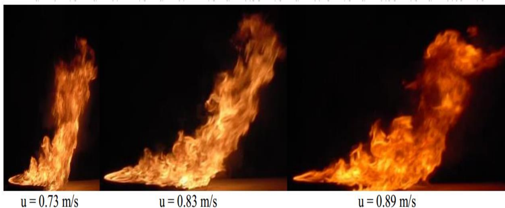
Εικόνα 5.2 Εικόνες από φλόγες που αναπτύσσονται υπό διαφορετικές τιμές της ταχύτητας του πλευρικού ανέμου (συνέχεια) [ 22].
