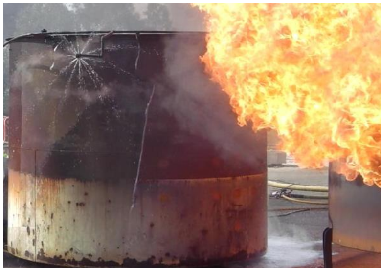
Εικόνα 7.4 Εφαρμογή της τεχνικής water spray για την ψύξη μίας δεξαμενής [108].
