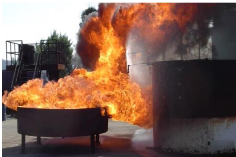
Εικόνα 7.2 Εφαρμογή της τεχνικής water curtain για την ψύξη μίας δεξαμενής [ 108].
