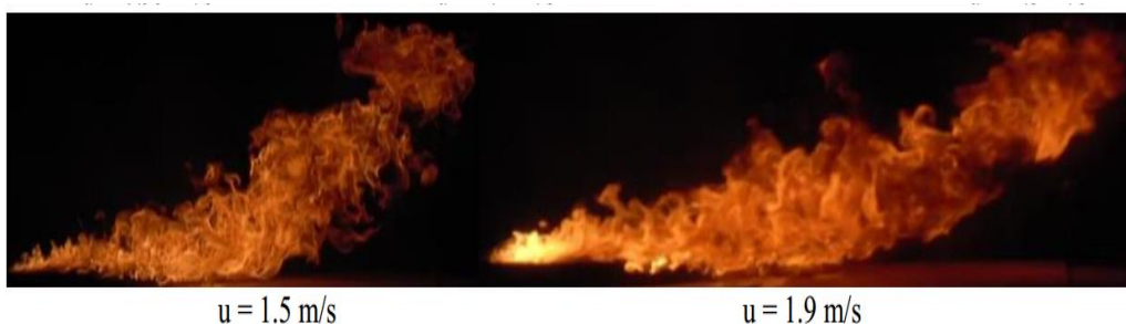
Εικόνα 5.4 Εικόνες από φλόγες που αναπτύσσονται υπό διαφορετικές τιμές της ταχύτητας του πλευρικού ανέμου (συνέχεια) [ 22].
