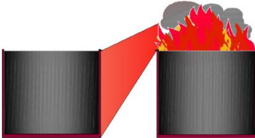
Εικόνα 7.8 Ακτινοβολία που λαμβάνεται από την προσκείμενη δεξαμενή, όπως θεωρήθηκε από την μελέτη των A. M. Ghasemi et al [ 107].
