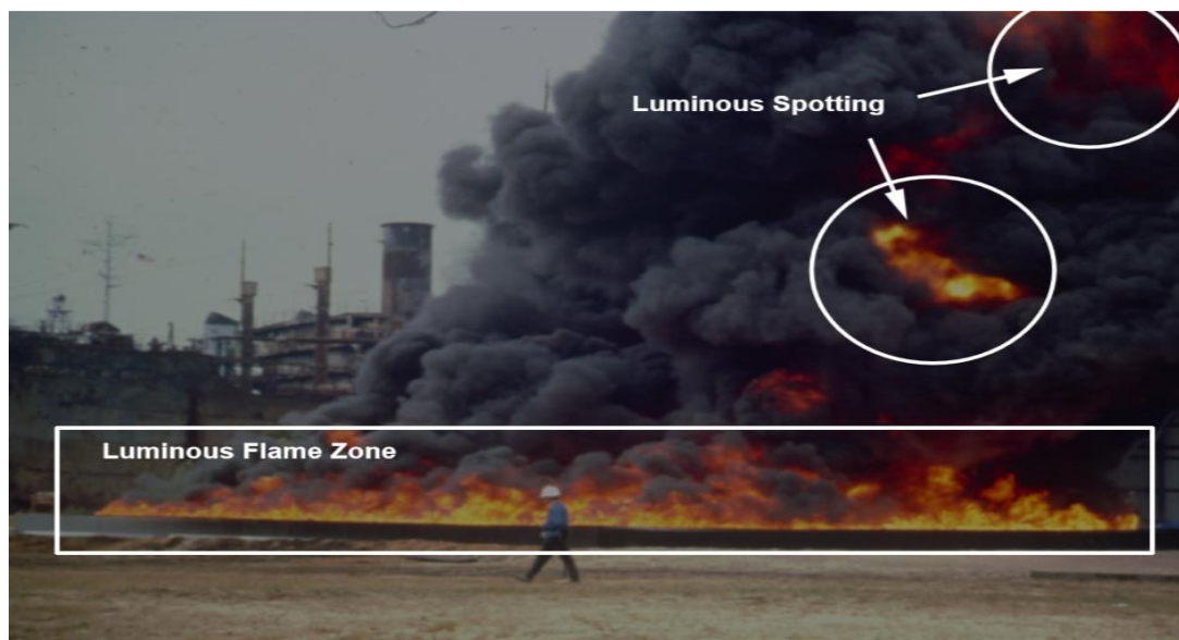
Εικόνα 3.3 Φωτογραφία από μία πυρκαγιά σε τετράγωνη δεξαμενή 15 m που περιέχει πετρέλαιο με νερό [ 26].
