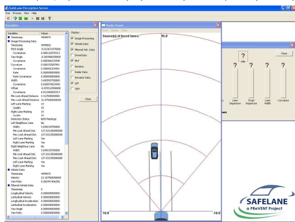
Σχήμα 3.20: Εφαρμογή πλευρικής ασφάλειας με σύντηξη δεδομένων για την εκτίμηση γεωμετρίας δρόμου
