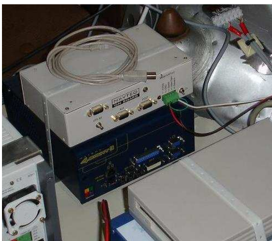
Σχήμα 5.26: Τοποθέτηση συστήματος εύρεσης GPS θέσης στο όχημα
