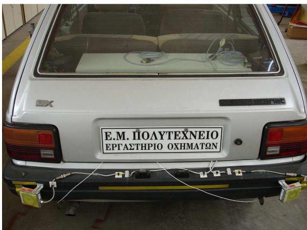
Σχήμα 5.22: Σημεία τοποθέτησης των δυο ραντάρ στο όχημα
