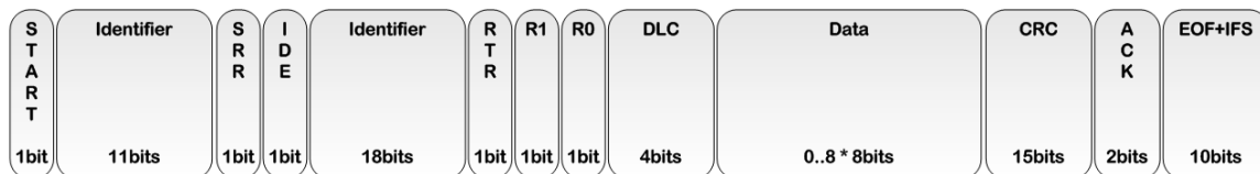
Σχήμα 5.3: Πλαίσιο CAN (εκτεταμένη μορφή, CAN 2.0B)
