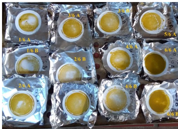
Εικόνα 19: Δείγματα κυττάρων μικροφυκών ύστερα από ξήρανση για τις εκάστοτε αραιώσεις από 1/6 έως 6/6 του αρχικού κυτταροδιαλύματος
