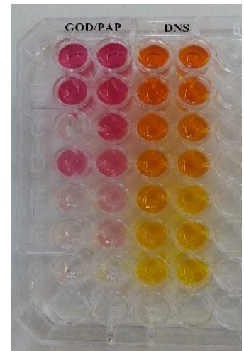
Εικόνα 22: Θέσεις μέτρησης πολυφωτόμετρου, στήλες 1-2 για τη μέθοδο ανίχνευσης GOD/PAP και 3-4 για τη μέθοδο DNS
