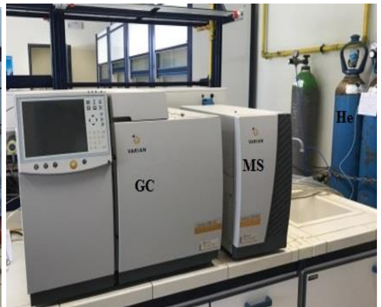
Εικόνα 28: Σύστημα αέριας χρωματογραφίας (GC) με τον αντίστοιχο ανιχνευτή
