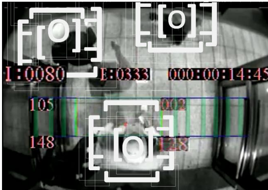
Εικόνα 23: Παράδειγμα υπολογιστικής όρασης. Η συγκεκριμένη εφαρμογή πρόκειται για μετρητής ανθρώπων σε δημόσιους χώρους όπως π.χ. ένα εμπορικό κέντρο.
