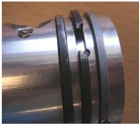
Σχήμα 4. Έμβολο με τα διάκενα και ελατήριά του
