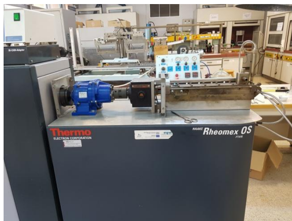
Εικόνα 5.3: Δικόχλιο σύστημα εκβολής Haake PTW 16.
