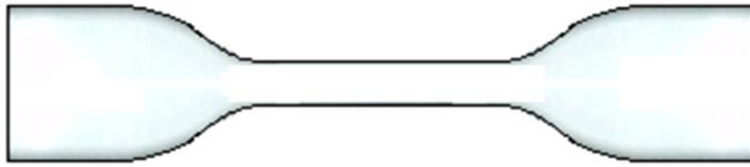
Εικόνα 6.17: Τυπικό δοκίμιο εφελκυσμού κατά τις προδιαγραφές του ASTM D638-03.
