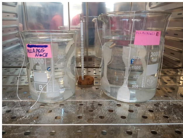
Εικόνα 7.3: Εμβάπτιση των δοκιμίων σε απεσταγμένο νερό στους 45°C.
