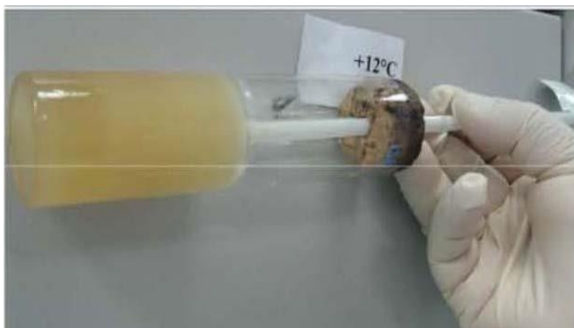
Σχήμα 5.2. Παραφινικοί σχηματισμοί στα αποστάγματα (Intertek Shipcare, 2017).
