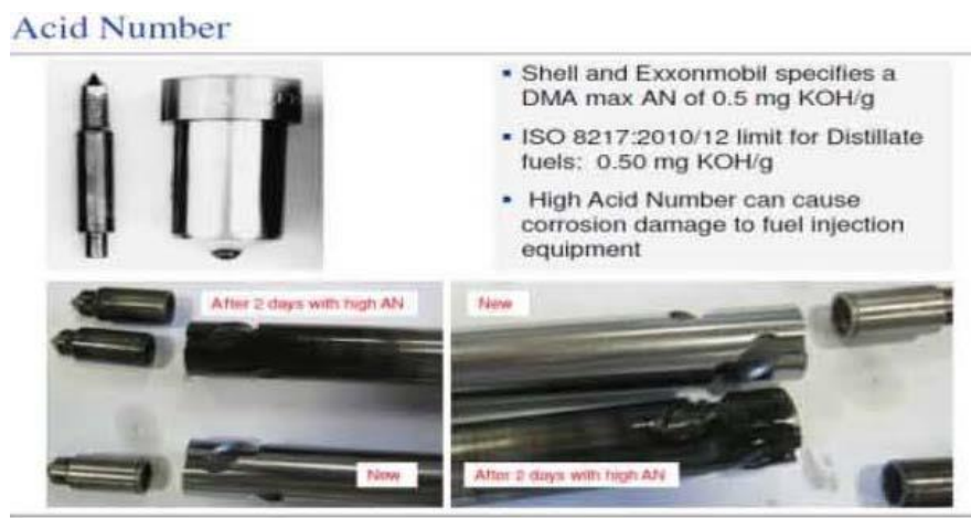
Σχήμα 5.3. Επιπτώσεις οξύτητας στο σύστημα ψεκασμού (CIMAC, 2013).
