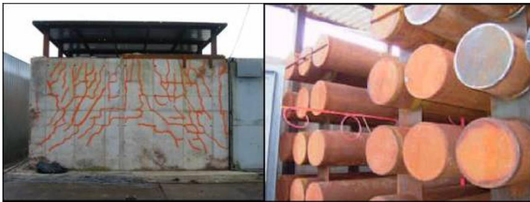
Σχήμα 8: Αριστερά – Δωμάτιο αποθήκευσης H_2 υψηλής πίεσης, Δεξιά – Διάταξη κυλίνδρων αποθήκευσης (Tanaka και συν., 2005)
