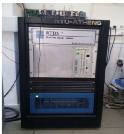
Εικόνα 4.1: Προσομοιωτής πραγματικού χρόνου (RTDS) εργαστηρίου ΣΗΕ του ΕΜΠ.
