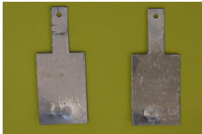
Εικόνα 28: Δοκίμια κράματος αλουμινίου 5052 μετά από 2011 ώρες έκθεση στο θάλαμο αλατονέφωσης με επικάλυψη: Paraloid B72 (10%)(αριστερά), Paraloid B72 (10%)-nano  $Al_2O_3$  (2%) (δεξιά)
