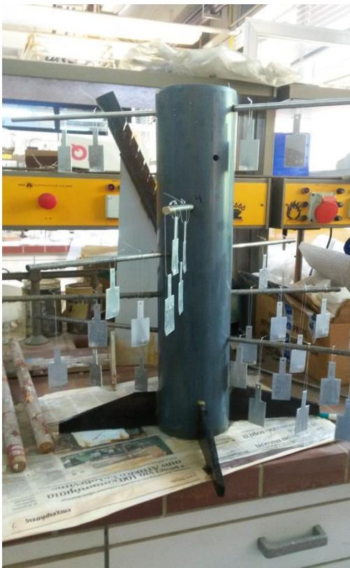
Εικόνα 2: Τοποθέτηση δοκιμών στο θάλαμο αλατονέφωσης
