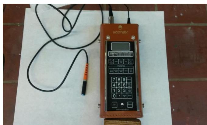
*Εικόνα 26: Παχύμετρο εργαστηρίου τύπου Elcometer F456*
