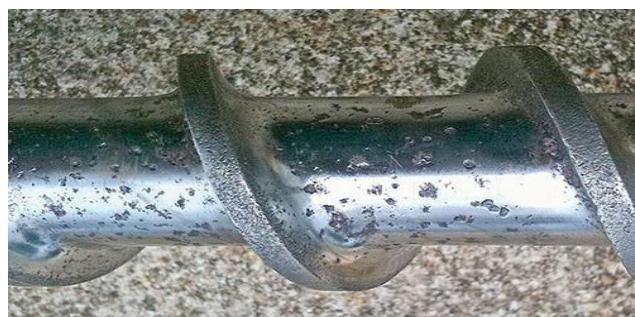
Εικόνα 8: Επιφάνεια μετάλλου που έχει υποστεί διάβρωση με βελονισμούς [17]
