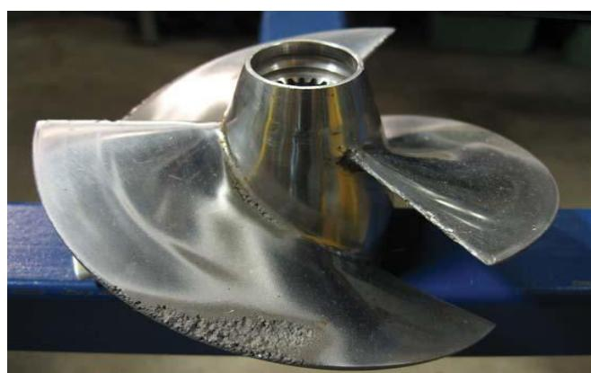
Εικόνα 11: Σπηλαιώδης διάβρωση σε μεταλλική επιφάνεια [20]
