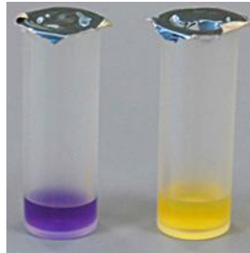
Εικόνα II.1. Αμπούλες του εμπορικού κιτ. Η δεξιά αμπούλα αφορά δείγμα που περιέχει αντιμικροβική ουσία και το χρώμα έχει παραμείνει μωβ ενώ στη δεξιά αμπούλα περιέχεται δείγμα που παρατηρείται ανάπτυξη του βακίλου.
