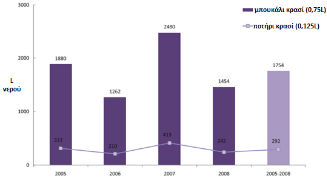
Διάγραμμα 3 Αποτελέσματα ΥΑ για ένα μπουκάλι και ποτήρι κρασιού για μια οινοπαραγωγική εταιρεία στη Ρουμανία
