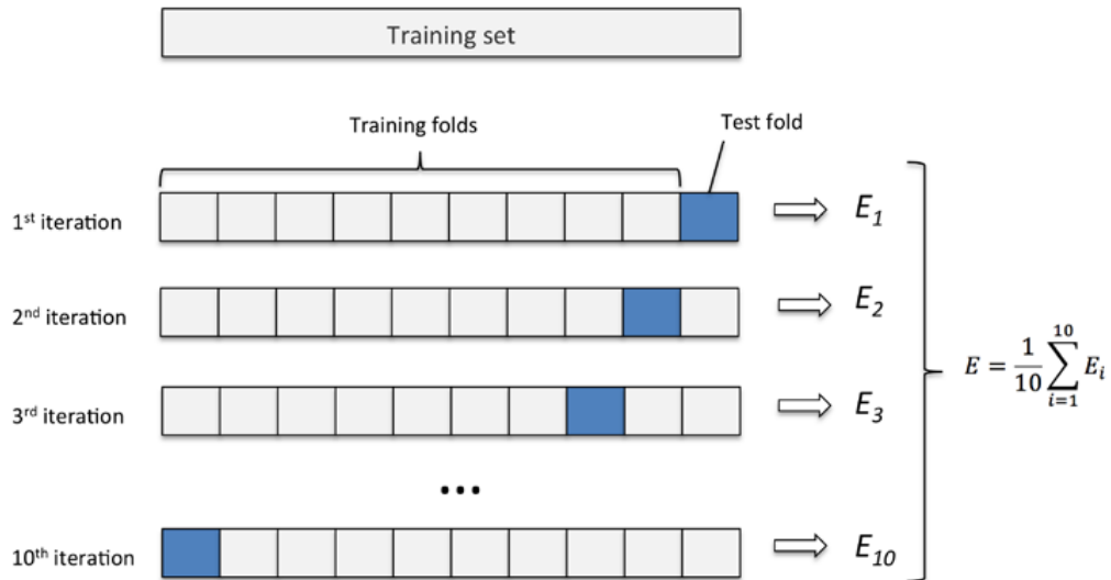
Εικόνα Β.14 Γραφική αναπαράσταση της διασταυρωμένης επικύρωσης k τμημάτων (παράδειγμα για k=10 )
