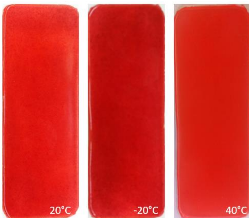
Εικόνα 35. Δοκίμιο 0.6 wt.% TCP/PDMS σε διάφορες θερμοκρασίες
