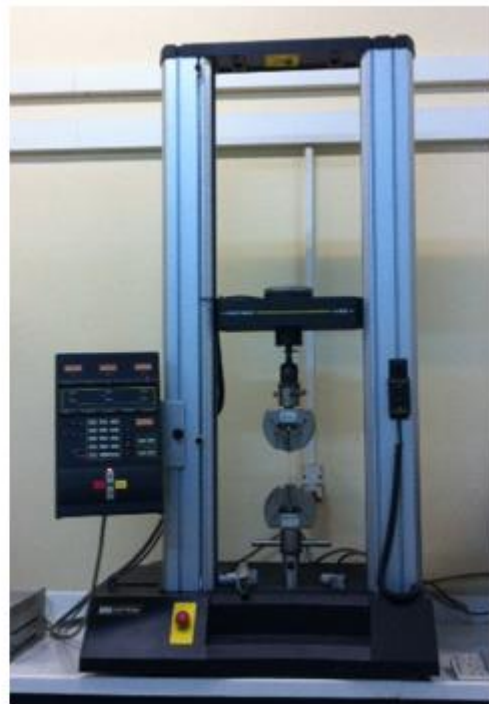
Εικόνα 24. Μηχάνημα κοπής δοκιμίων εφελκυσμού (αριστερά), διάταξη δοκιμής σε εφελκυσμό (δεξιά)
