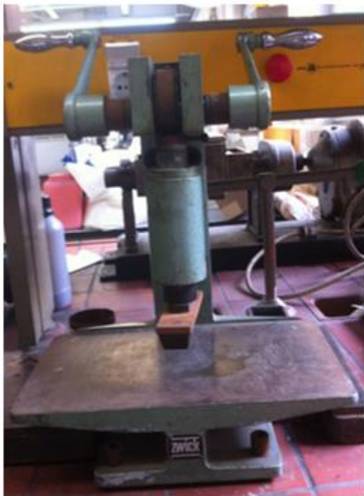
Εικόνα 24. Μηχάνημα κοπής δοκιμίων εφελκυσμού (αριστερά), διάταξη δοκιμής σε εφελκυσμό (δεξιά)
