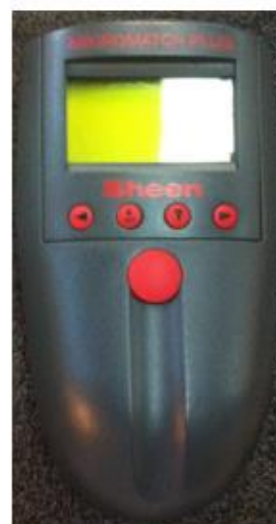
Εικόνα 26. Συσκευή εκπομπής UV ακτινοβολίας (αριστερά), όργανο μέτρησης παραμέτρων L a* b* (δεξιά)
