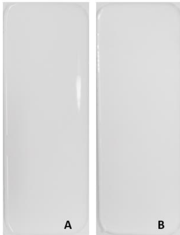
Εικόνα 40. Δοκίμιο 2 wt.% TiO_2 /PDMS (A) αναφοράς, (B) μετά από 258 h έκθεσης σε UV ακτινοβολία
