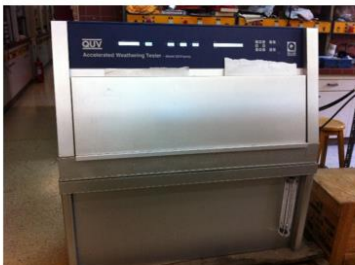
Εικόνα 26. Συσκευή εκπομπής UV ακτινοβολίας (αριστερά), όργανο μέτρησης παραμέτρων L a* b* (δεξιά)
