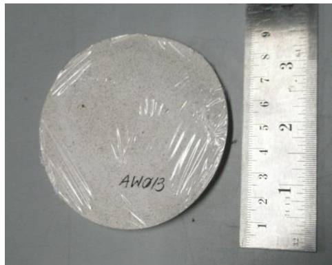
Εικόνα 6.15: Χρησιμοποιημένο και συσκευασμένο φίλτρο νερού βροχής.
