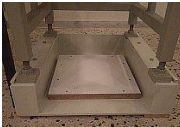
Εικόνα 2.37: Η διάταξη κοιλοδοκών για την ανύψωση του ανιχνευτικού συστήματος.
