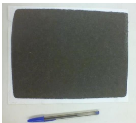
Εικόνα 7.4: Φίλτρο FP810M 8 x 10" μετά από δειγματοληψία 5 ημερών (120 h).
