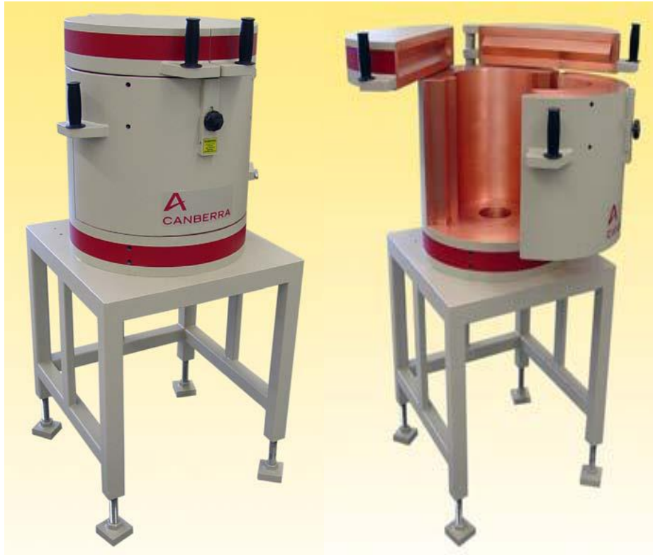
Σχήμα 2.2: Η θωράκιση του ανιχνευτή XtRa μοντέλο 767 της Canberra Industries.
