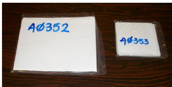
Εικόνα 7.3: Φίλτρο FP810M σε γεωμετρία «12» (αριστερά) και γεωμετρία «10» (δεξιά)
