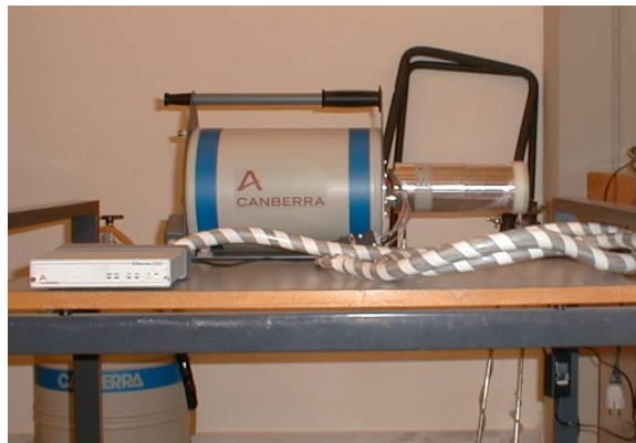
Εικόνα 2.5: Η in-situ διάταξη BEGe του Ε.Π.Τ. - Ε.Μ.Π.
