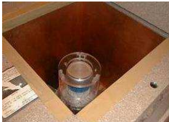
Εικόνα 2.2: Ο ανιχνευτής HPGe σχετικής απόδοσης 33.8% του Ε.Π.Τ. - Ε.Μ.Π.
