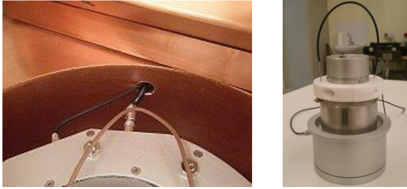
Εικόνα 2.40: Οπή στη θωράκιση της ανιχνευτικής διάταξης για τη σύνδεση των καλωδίων του ανιχνευτή NaI(Tl) (αριστερά) και δακτύλιος ασφαλούς αφαίρεσης plug ανιχνευτή (δεξιά) .
