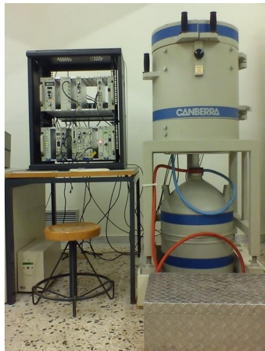
Εικόνα 2.43: Η ανιχνευτική διάταξη XtRa μετά την εγκατάσταση του C.S.S.
