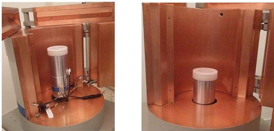
Εικόνα 2.36: Η θέση του ανιχνευτή ΧtRa εντός της παθητικής θωράκισης (αριστερά: πριν την εγκατάσταση του C.S.S., δεξιά: μετά την μετατόπισή του σε χαμηλότερη θέση).
