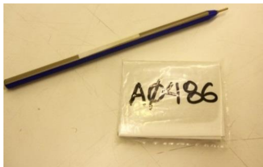
Εικόνα 6.7: Φίλτρο από ίνες γυαλιού 8×10" διπλωμένο σε γεωμετρία 10.
