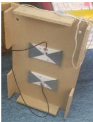
Σχήμα 4.19 Κεραιές παπιγιόν παράλληλες στο εργαστήριο
