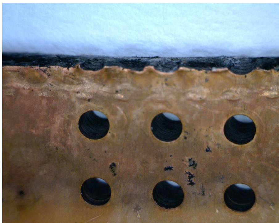
Σχήμα 109 – Φωτογραφία δοκιμίου Z8 μετά την απόθεση πολυπυρρόλης και πριν την επιχάλκωση
