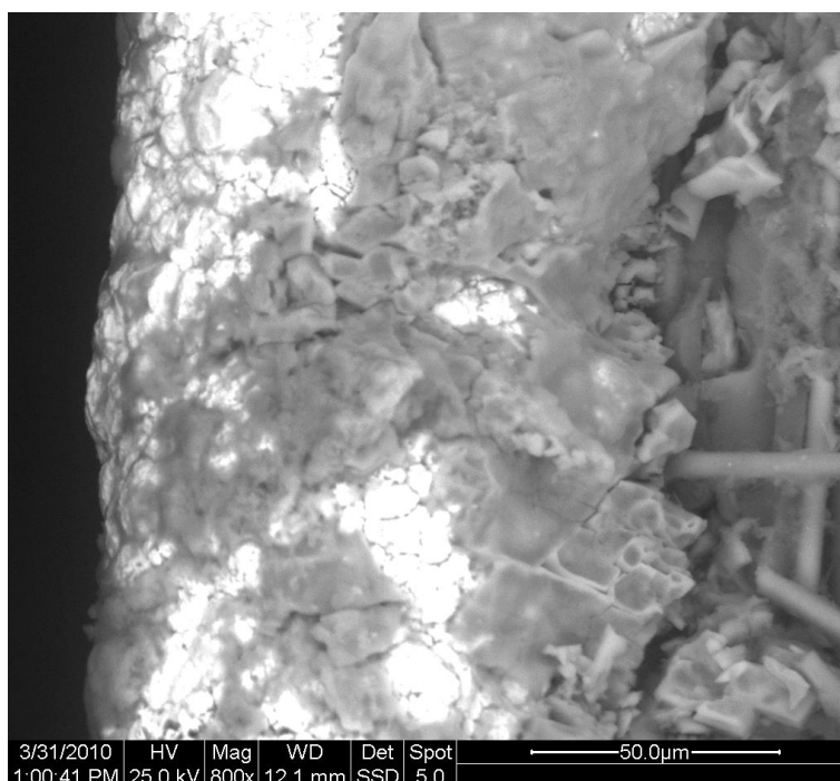
Σχήμα 125 – Φωτογραφία SEM περιοχής επιχλωμένης οπής (f15). Διακρίνονται οι ίνες γυαλιού του FR4. [μεγέθυνση x800]
