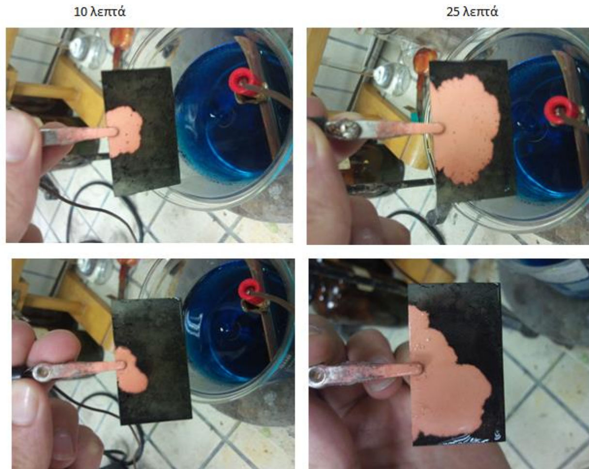
Σχήμα 73 – Δοκίμιο H2-2: Φωτογραφίες της εξέλιξης της διαδικασίας της επιχάλκωσης. Το μέτωπο του χαλκού μεταδίδεται σταδιακά από τις επιχάλκωμένες περιοχές προς την υπόλοιπη επιφάνεια του δοκιμίου.
