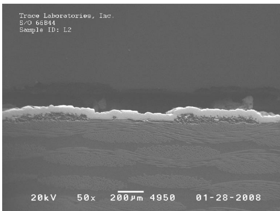
Σχήμα 50 – Φωτογραφία SEM διατομής επιχλωμένου δοκιμίου E2. Ομοιόμορφη απόθεση χαλκού χωρίς ατέλειες [μεγέθυνση x50]
