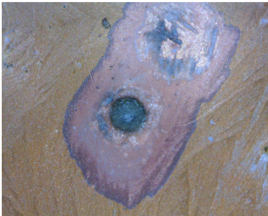
Σχήμα 101 – Φωτογραφία φραγμένης οπής δοκιμίου Z5 εξαιτίας μη αφαίρεσης αποθέσεων πολυπυρρόλης πριν την επιχάλκωση
