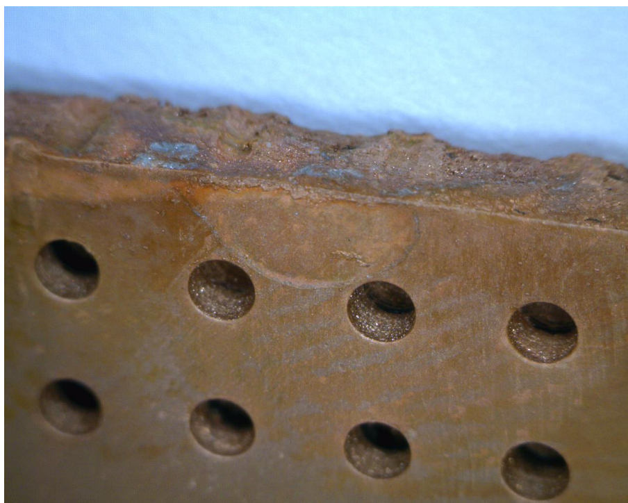
Σχήμα 111 – Φωτογραφία δοκιμίου Z8 μετά την επιχάλκωση. Διακρίνεται η πλήρης κάλυψη των τοιχωμάτων των οπών με χαλκό.
