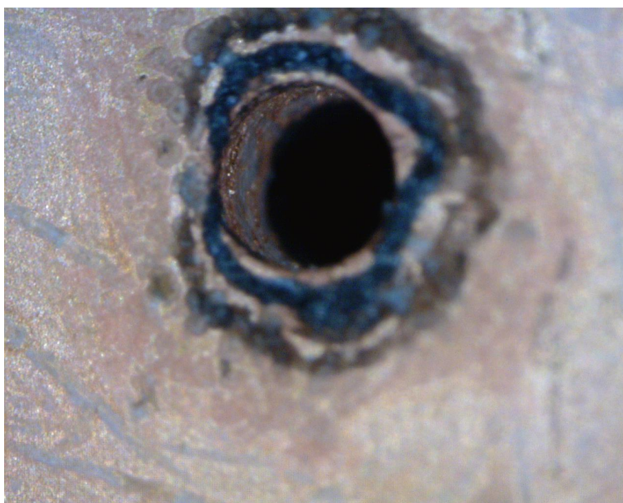
Σχήμα 100 – Φωτογραφία επιχάλκωμνης οπής δοκιμίου Z4. Εμφανείς αποθέσεις πολυπυρρόλης στην επιφάνεια του τυπωμένου κυκλώματος οι οποίες θα πρέπει να αφαιρεθούν με επιπλέον επεξεργασία
