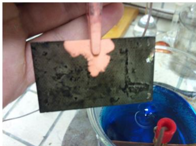
Σχήμα 76 – Δοκίμιο H3-2: Εξέλιξη της επιχάλκωσης. Η πίσω πλευρα επιχάλκώθηκε πιο γρήγορα εξαιτίας της γεωμετρίας της διάταξης.
