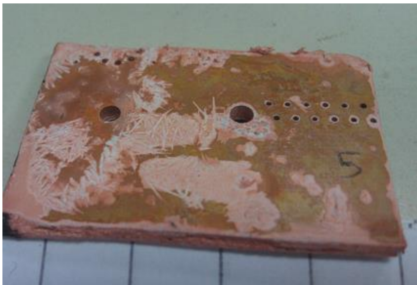
Σχήμα 132 – Φωτογραφία επιχαλωμένων οπών δοκιμίου H4-5. Εμφανής η επιπλέον απόθεση χαλκού στην επιφάνεια.
