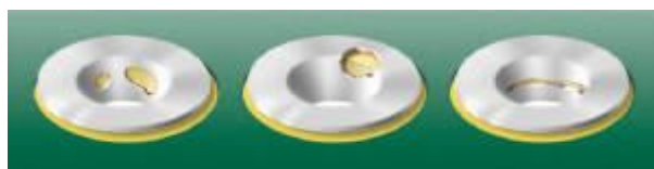
Σχήμα 87 – Κενά επιχάλκωσης οπών σε PCB
