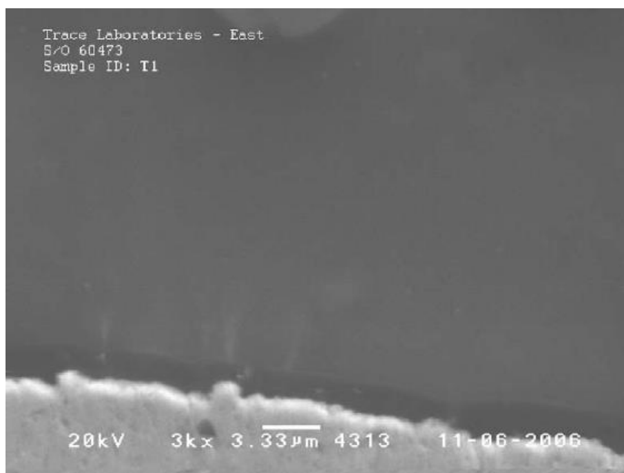
Σχήμα 29 – Φωτογραφία SEM διατομής επιχαλκωμένου δοκιμίου Δ1. Διακρίνεται το στρώμα πολυπυρρόλης μεταξύ FR4 (στο πάνω μέρος της φωτογραφίας) και χαλκού (κάτω μέρος της φωτογραφίας), όπως και τα ίχνη διάχυσης του χαλκού στο FR4. [μεγέθυνση x3,000]
