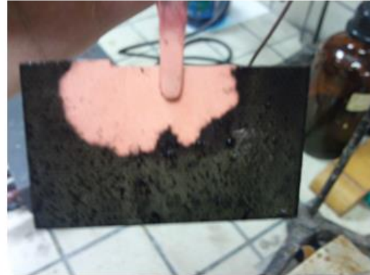
Σχήμα 75 – Δοκίμιο H3-1: Εξέλιξη της επιχάλκωσης. Διακρίνεται η διάδοση του μετώπου του χαλκού από το σημείο της ηλεκτρικής επαφής.
