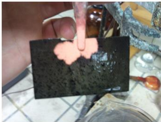
Σχήμα 75 – Δοκίμιο H3-1: Εξέλιξη της επιχάλκωσης. Διακρίνεται η διάδοση του μετώπου του χαλκού από το σημείο της ηλεκτρικής επαφής.
