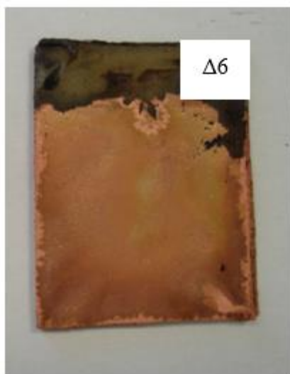
Σχήμα 40 – Δοκίμιο Δ6 μετά το πέρας της επιχάλκωσης (το μη επιχάλκωμένο τμήμα είναι το τμήμα που βρισκόταν εκτός του διαλύματος επιχάλκωσης)
