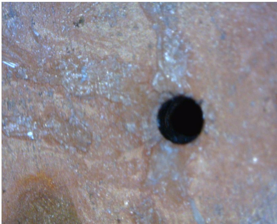
Σχήμα 106 – Φωτογραφία οπής μικρής διαμέτρου του δοκιμίου Z7 μετά την απόθεση πολυπυρρόλης στα τοιχώματα της
