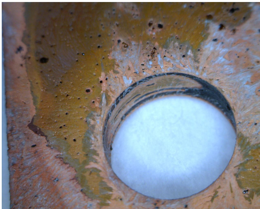
Σχήμα 99 – Φωτογραφία δοκιμίου Z3 κατά τη διάρκεια της επιχάλκωσης. Τα τοιχώματα της οπής έχουν επιχάλκωθεί μερικώς με το υπόλοιπο τμήμα να είναι επικαλυμμένο με πολυπυρρόλη
