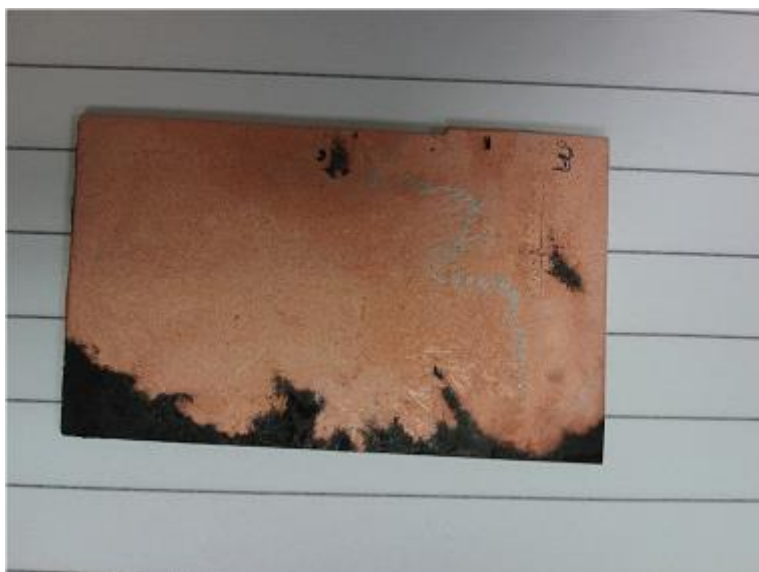
Σχήμα 131 – Φωτογραφία δοκιμίου H3-1 λίγο πριν την ολοκλήρωση της επιχάλκωσης της επιφάνειάς του. Εμφανής η διάδοση του μετώπου του χαλκού
