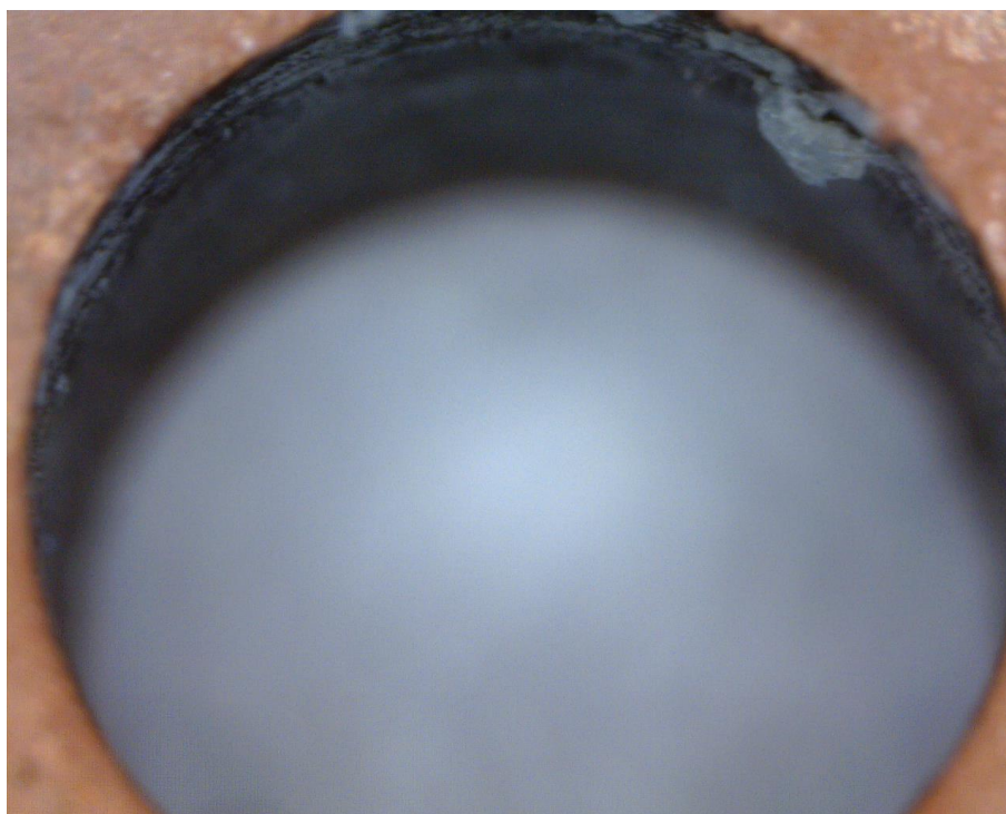
Σχήμα 107 – Φωτογραφία οπής μεγάλης διαμέτρου του δοκιμίου Z7 μετά την απόθεση πολυπυρρόλης
