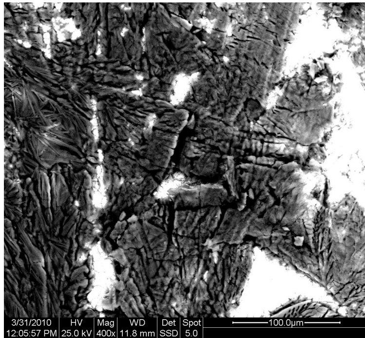
Σχήμα 115 – Φωτογραφία SEM επιχλωμένου τοιχώματος οπής τυπωμένου κυκλώματος. Διακρίνονται μικρο-ατέλειες στην απόθεση (περιοχή f8) [μεγέθυνση x400]
