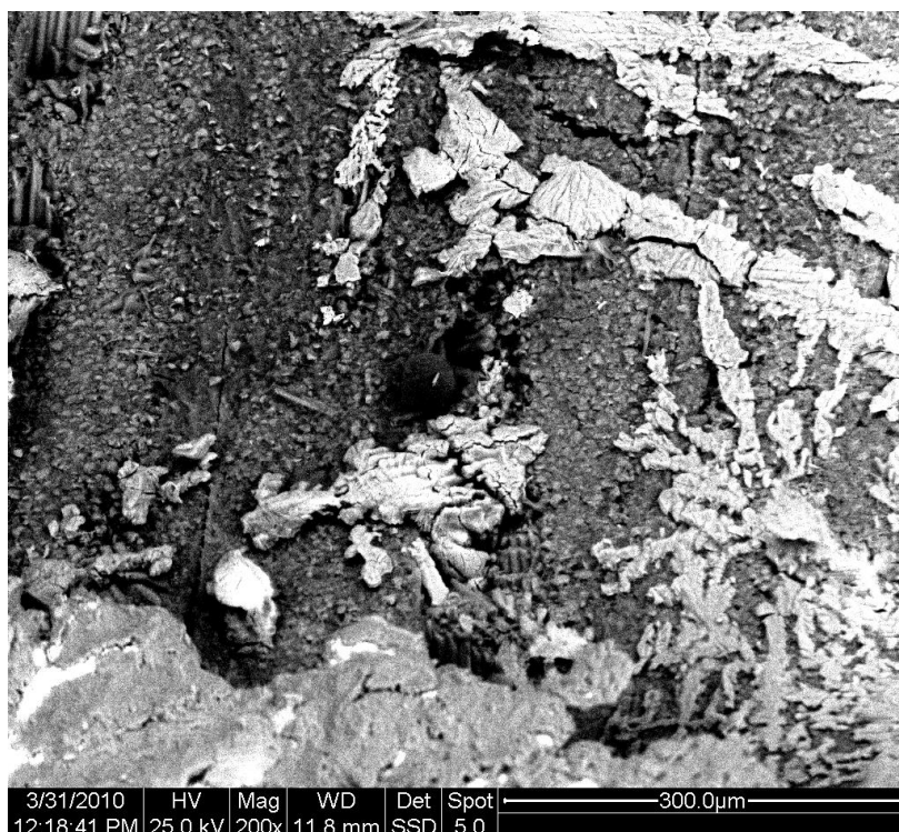
Σχήμα 117 – Φωτογραφία SEM τοιχώματος οπής τυπωμένου κυκλώματος κατά τη διάρκεια επιχάλκωσης (περιοχή f9) [μεγέθυνση x200]
