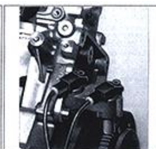
Σχήμα 3. Εντολοδότης στροφών (αριστερά) Εντολοδότης γωνίας στροφάλου (δεξιά)
