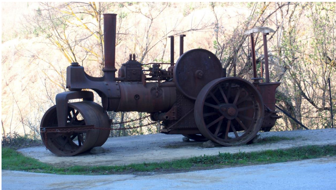
Εικόνα 32. Ο παλιός ατμοκίνητος οδοστρωτήρας
