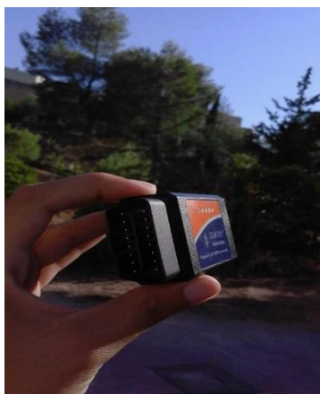
Εικόνα 5.6 α,β. Φορητό OBD II - Pro Interface 327 BLUETOOTH, α) πριν την τοποθέτησή του και β) συνδεδεμένο και έτοιμο για πειραματική μέτρηση συλλογής δεδομένων κίνησης. (Ιδία επεξεργασία)
