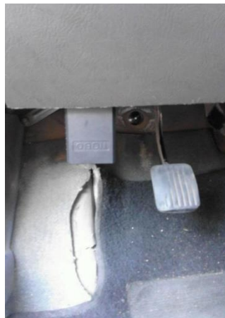
Εικόνα 5.6 α,β. Φορητό OBD II - Pro Interface 327 BLUETOOTH, α) πριν την τοποθέτησή του και β) συνδεδεμένο και έτοιμο για πειραματική μέτρηση συλλογής δεδομένων κίνησης. (Ιδία επεξεργασία)
