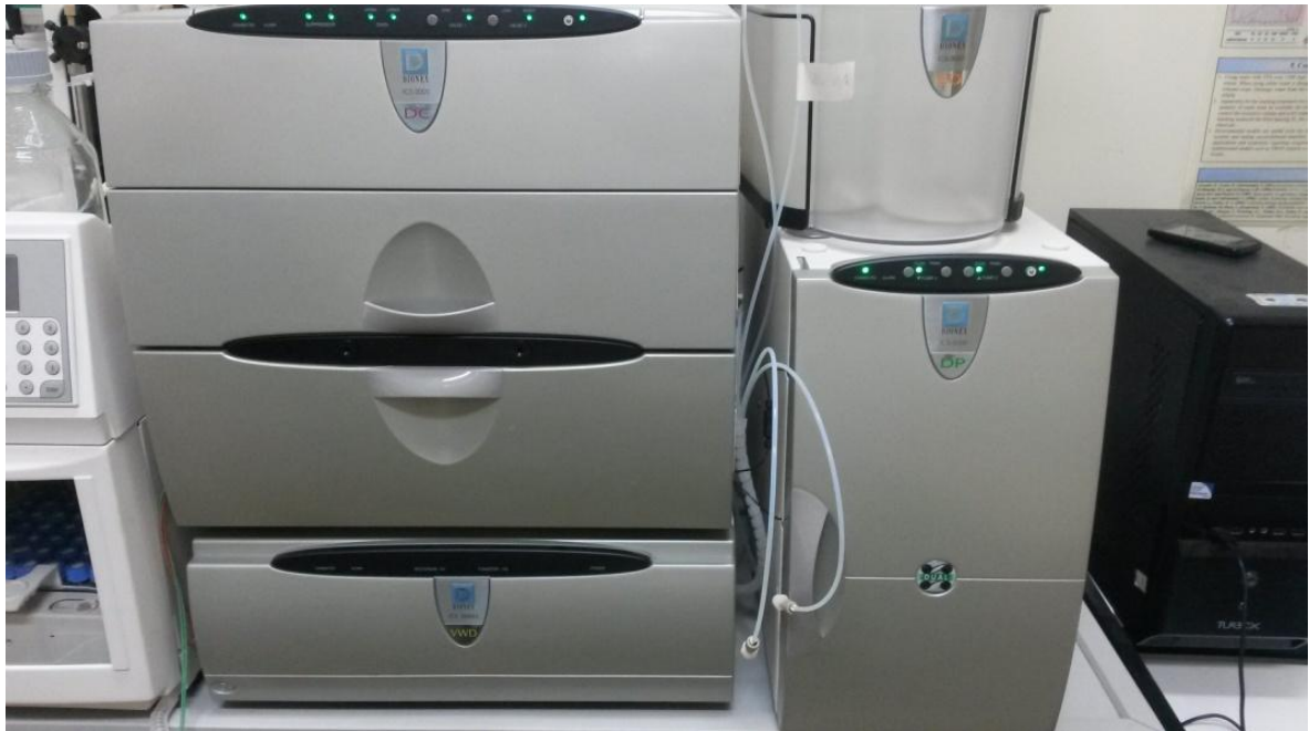
Εικόνα 3.4: Όργανο ιοντικής χρωματογραφίας DIONEX ICS – 3000.
