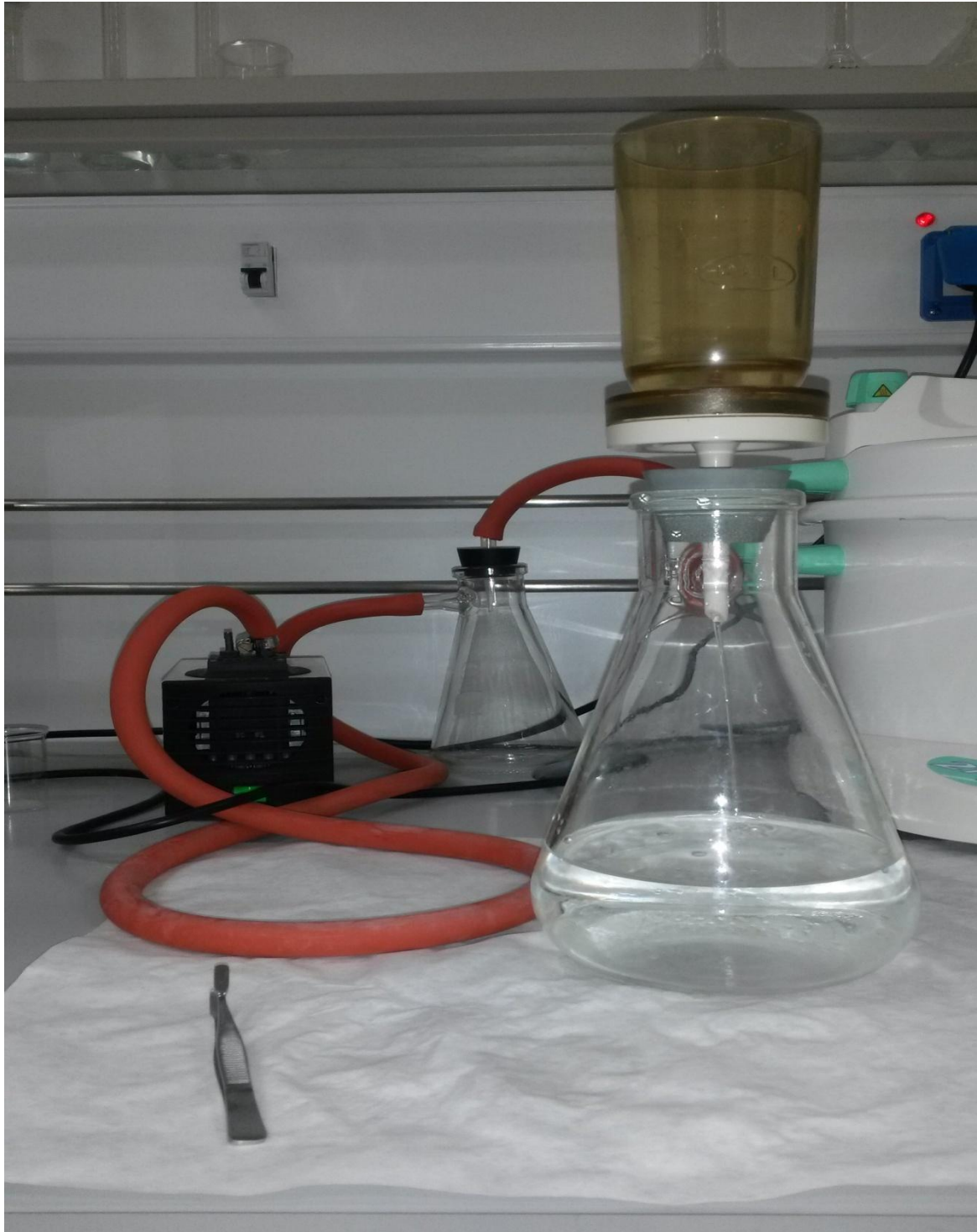
Εικόνα 3.2: Αντλία κενού για τη διήθηση των δειγμάτων νερού και τον προσδιορισμό των αιωρούμενων στερεών – Διαδικασία διήθησης.
