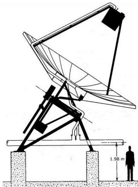
Σχήμα 2.8: Πρωτότυπο παραβολικό πιάτο που χρησιμοποιείται στο εργοστάσιο θερμικής συμπαραγωγής με ηλιακή ενέργεια στην Shenandoah, GA. [2.9]
