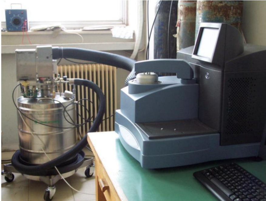
Εικόνα 2.6: Η διάταξη Q200 DSC του ερευνητικού εργαστηρίου θερμικής ανάλυσης. [64]
