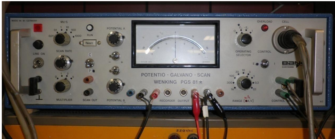
Φωτογραφία 5.2: Ποτενσιοστάτης Wenking μοντέλο PGS 81R.
