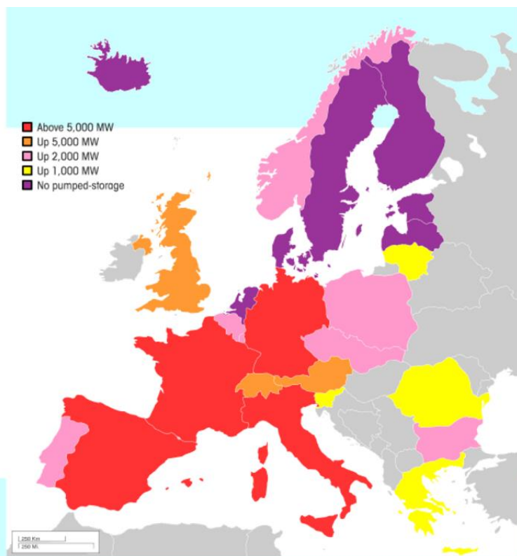
Εικόνα 1.1: Εγκατεστημένη ισχύς αντλησιοταμίευσης τις αρχές του 2011 [9]
