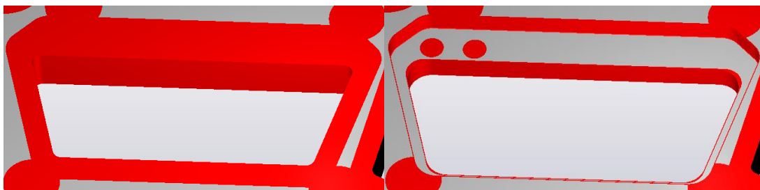
Εικόνα 4.36: Εκκαθάριση του αριστερού παραθύρου από την πρώτη ύλη
