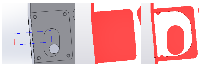
Εικόνα 4.26: Τροχιά εργαλείου (αριστερά), Τεμάχιο προ (κέντρο) και μετά (δεξιά) κατεργασίας
