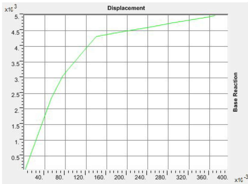
Σχήμα 3- 2: καμπύλη ικανότητας για τη χ διεύθυνση του διώροφου
