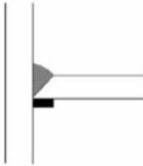
Εικόνα 1- 4: Συγκόλληση δοκού-υποστυλώματος με τη βοήθεια ράβδου υποστηρίξης
