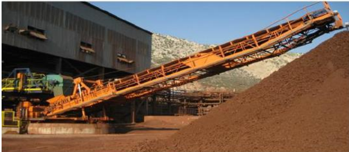
Εικόνα 11. Κατάλοιπα βωξίτη μετά την απομάκρυνση του περιεχόμενου ύδατος από τις φιλτρόπρεσες (ΑτΕ).
