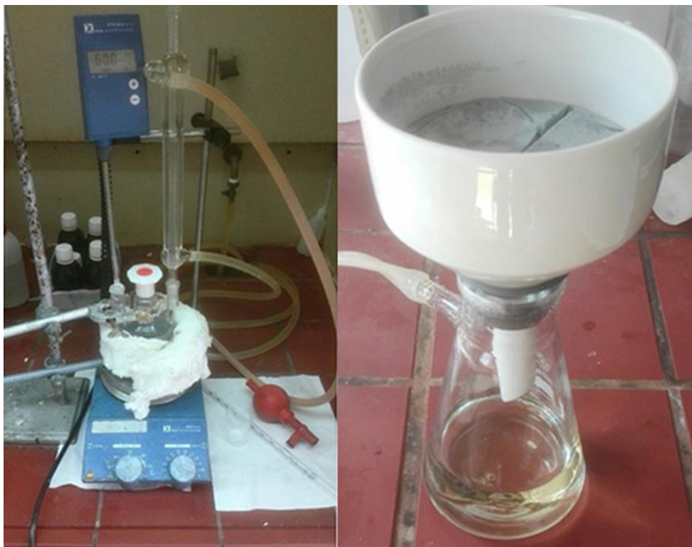
Εικόνα 23. Γενική διάταξη πειραμάτων εκχύλισης (αριστερά). Διήθηση πολφού μετά το πέρας 24 ωρών (δεξιά).
