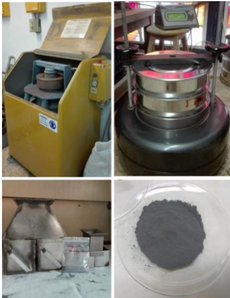
Εικόνα 19. Διαδικασία θραύσης (αριστερά επάνω), κοσκίνησης (δεξιά επάνω), δειγματοληψία με τη μέθοδο Jones (αριστερά κάτω) και τελική μορφή δείγματος (δεξιά κάτω).
