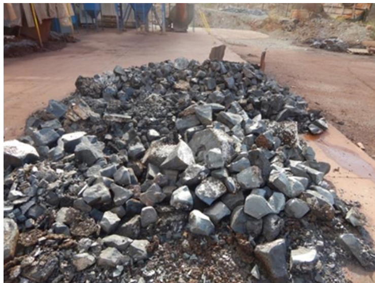
Εικόνα 17. Πιληθώματα σκωρίας, από την εφαρμογή του ENEXAL στο Αλουμίνιο της Ελλάδος.
