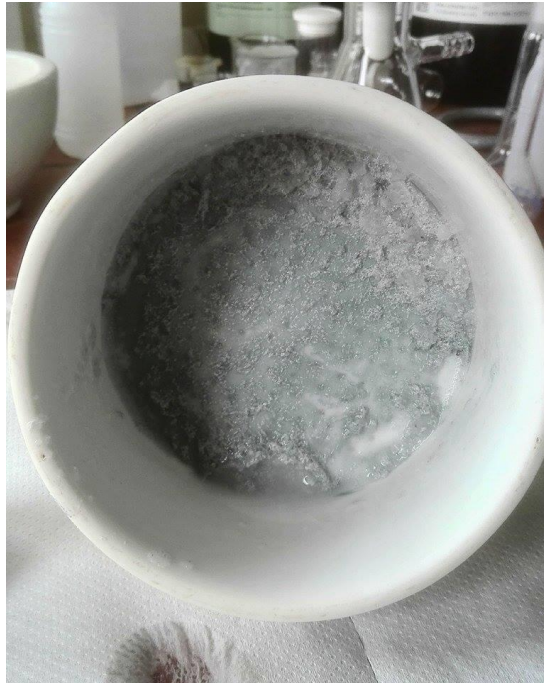
Εικόνα 41. Στρώμα γέλης πυριτίου κατά τη διήθηση.
