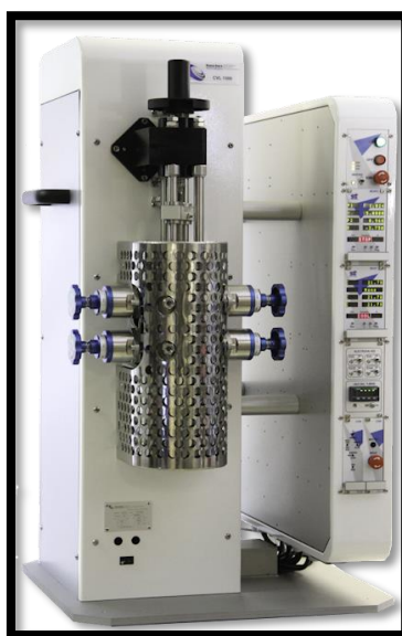
Σχήμα 4.4 Ιξωδόμετρο τριχοειδούς ροής (Core Laboratories).
