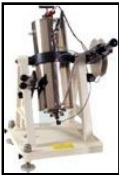
Σχήμα 4.3 Ιξωδόμετρο κυλιόμενης σφαίρας ( www.Chandlerengineering.com ).
